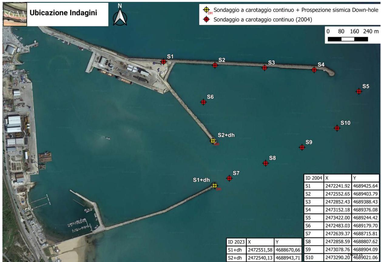
Figura 2-3. Georeferenziazione dei punti di dei sondaggi geognostici a mare eseguiti nel 2004 ed integrati con due sondaggi sulle testate di estremità della vecchia diga nord e dell'attuale diga sud
