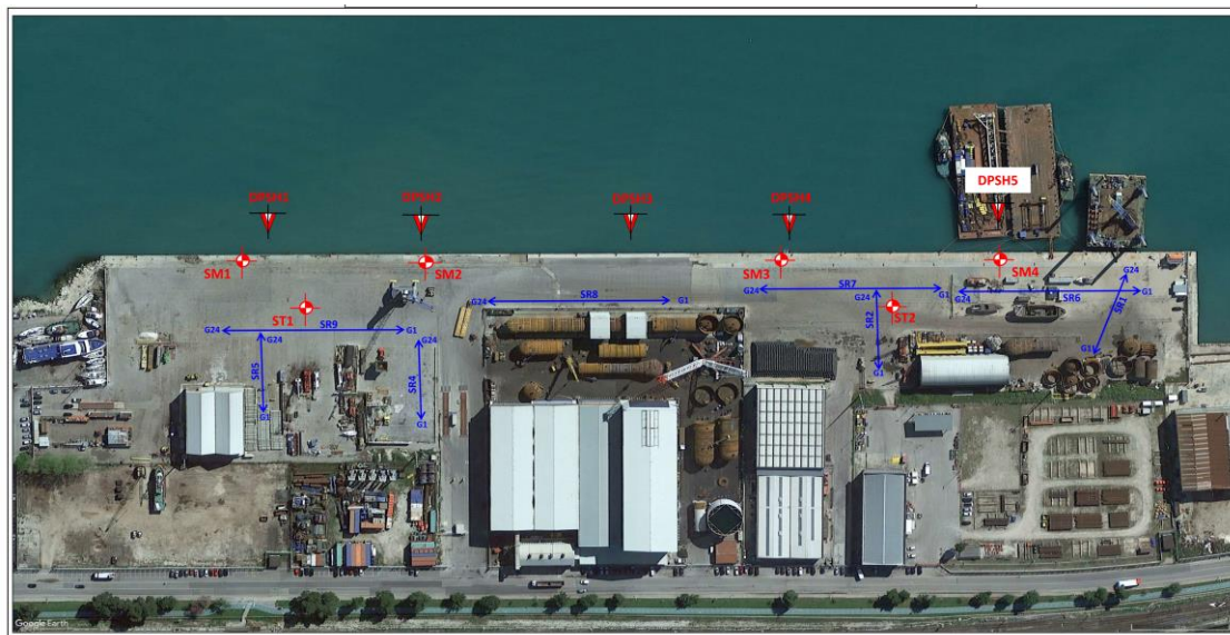
LEGENDA Sondaggio geognostico a carotaggio continuo Prova penetrometrica dinamica DPSH Stendimento indagine sismica a rifrazione
