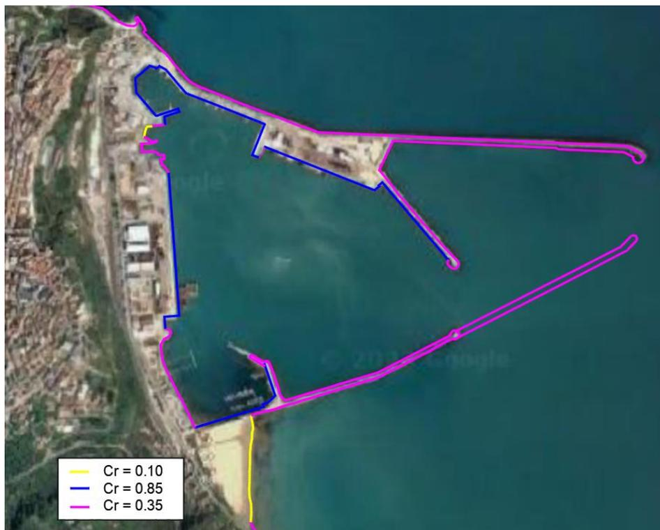
Figura 3-2 - Coefficienti di riflessione degli elementi di contorno per il modello VEGA.
