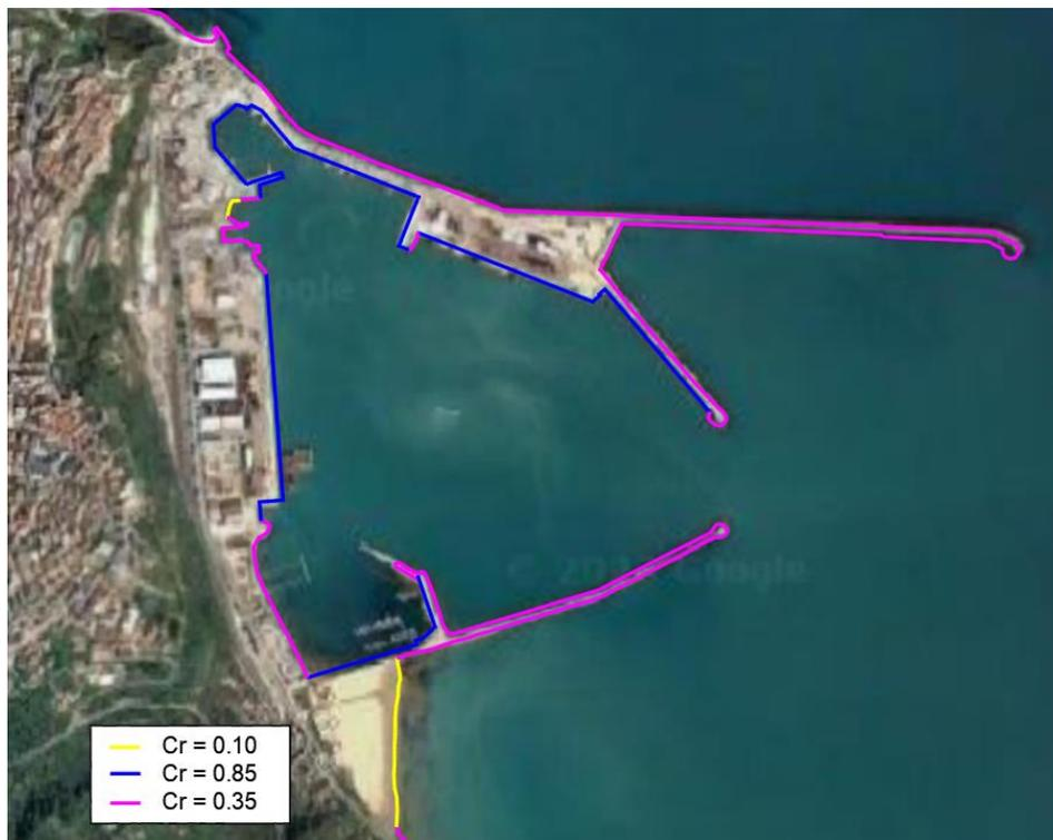
Figura 3-1 - Coefficienti di riflessione degli elementi di contorno per il modello VEGA
