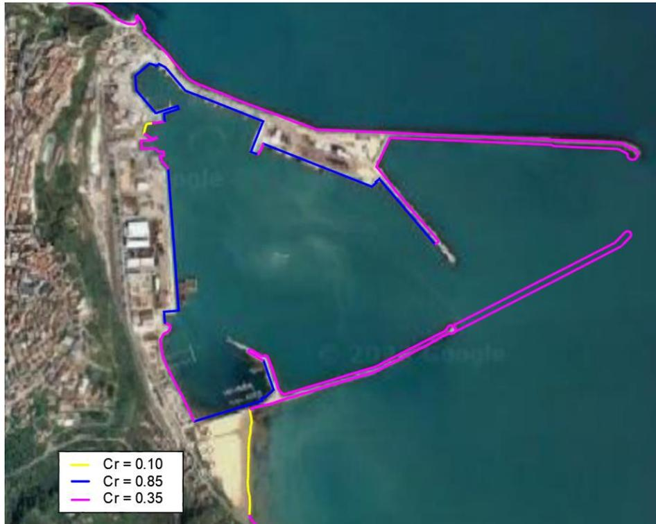
Figura 3-3 - Coefficienti di riflessione degli elementi di contorno per il modello VEGA-Configurazione di Progetto “completa” ovvero anche con la resecazione del Molo Nord
