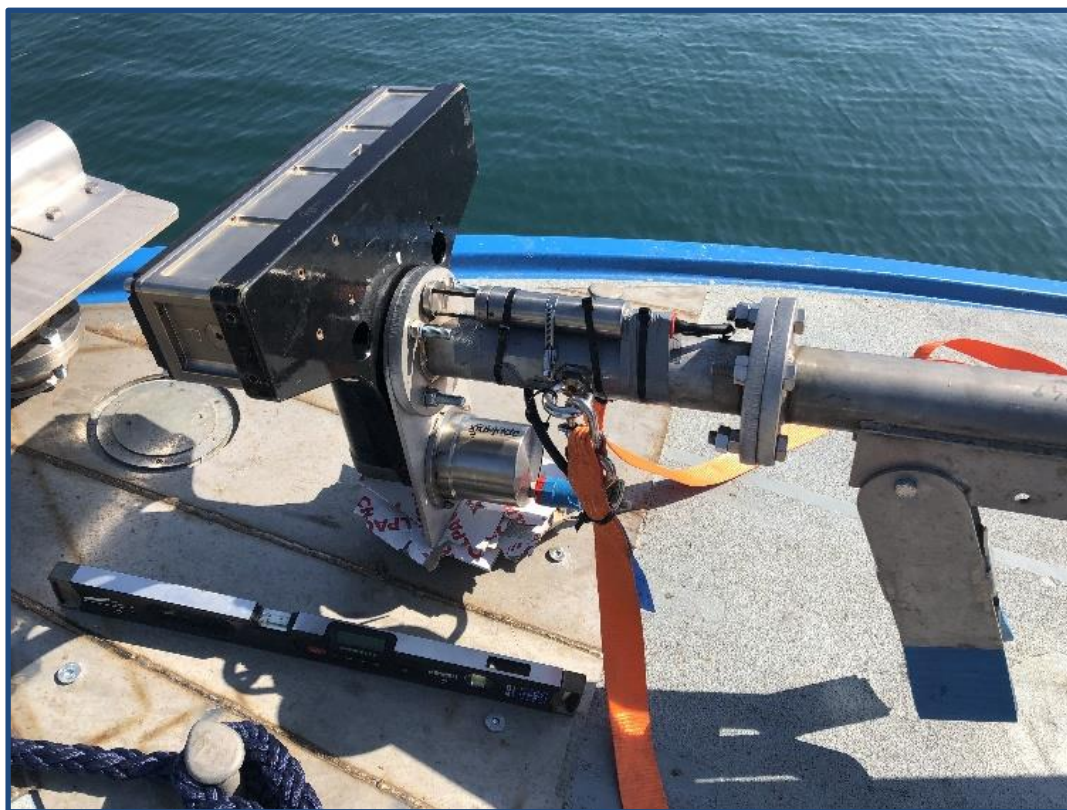
Figura 5: installazione MBES a bordo del Maestrale Primo .
