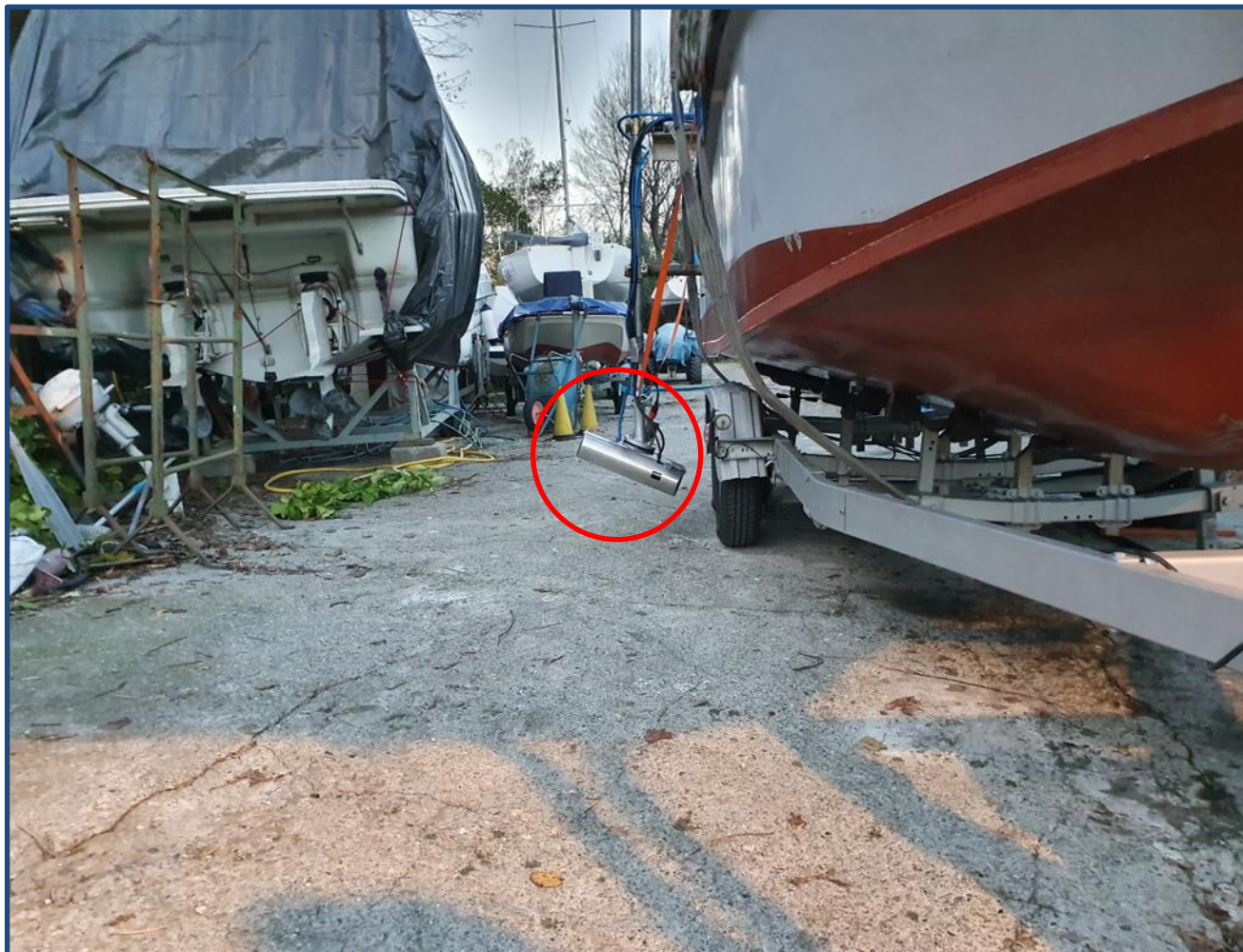
Figura 4: esempio di Multi Beam installato in modalità testa inclinata.
