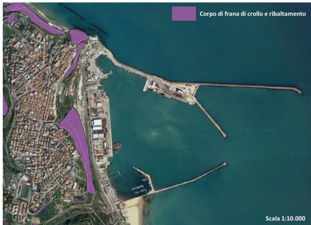
Figura 4-9 PAI - Aree interessate da frana di crollo e ribaltamento
