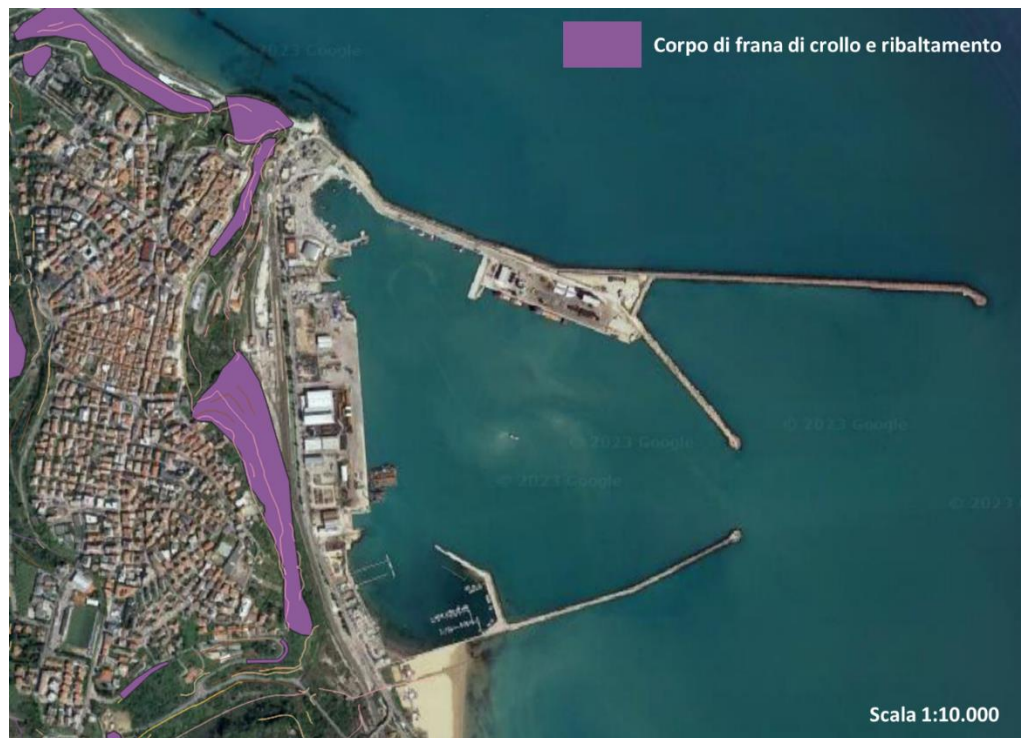
Figura 4-4 PAI - Aree interessate da frana di crollo e ribaltamento
