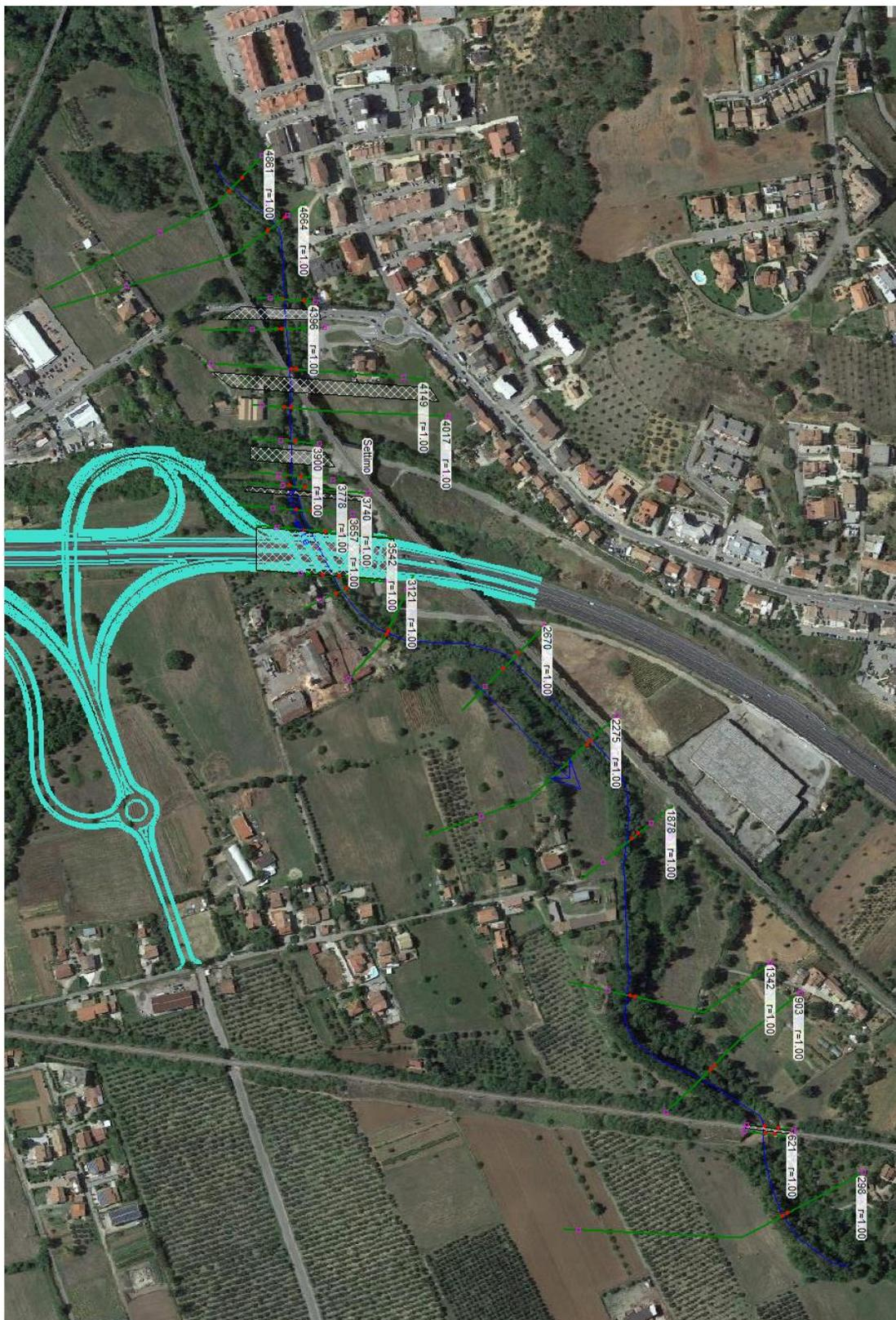
Fig. 27: Planimetria modello idraulico T. Settimo su modello digitale del terreno - stato progetto
