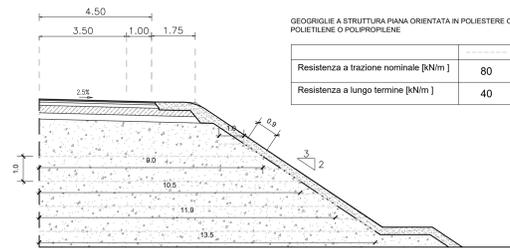
PARTICOLARE AMMORSAMENTO RILEVATO ESISTENTE
