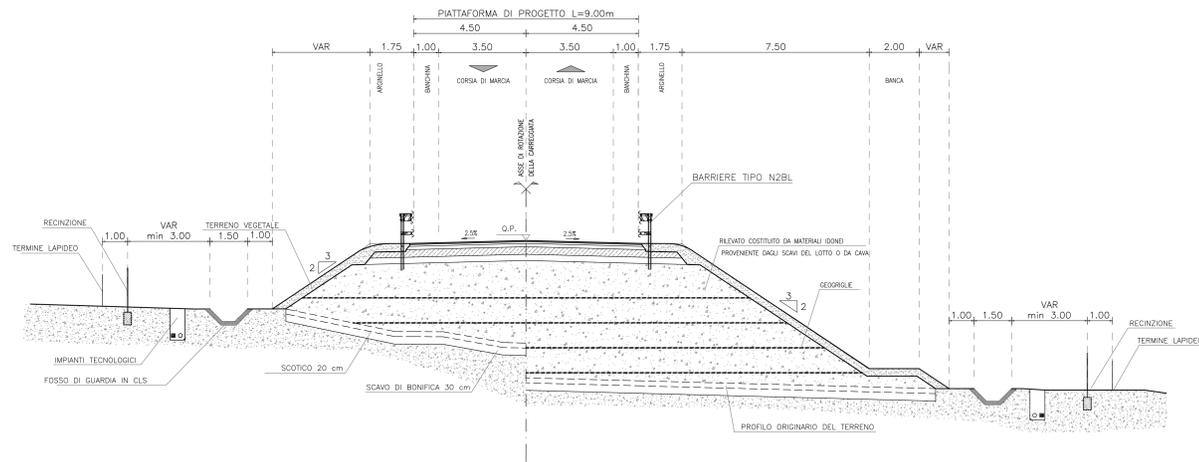
SEZIONE TIPO IN RILEVATO - IN CURVA
