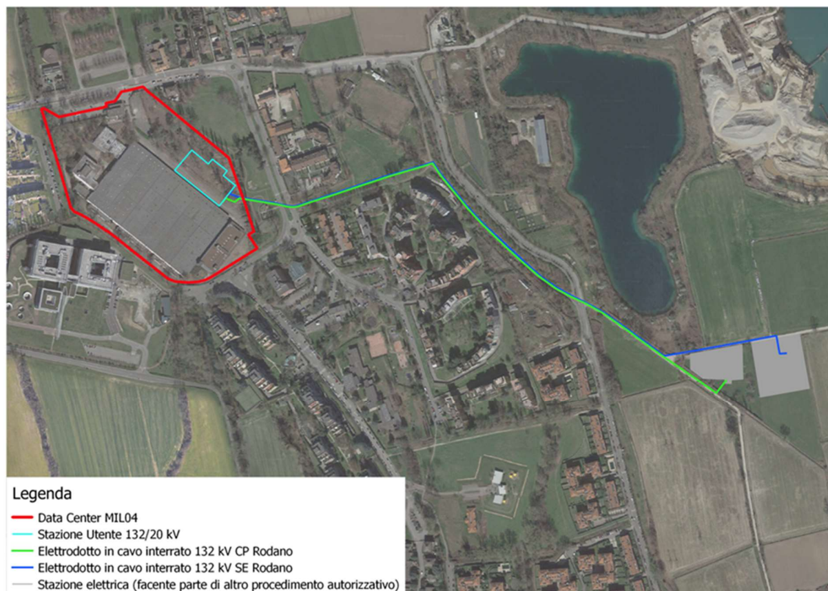
Figura 2: Nuova Stazione Utente per MIL04 e collegamento alla Cabina Primaria esistente e alla Stazione Elettrica in progetto nel comune di Rodano
