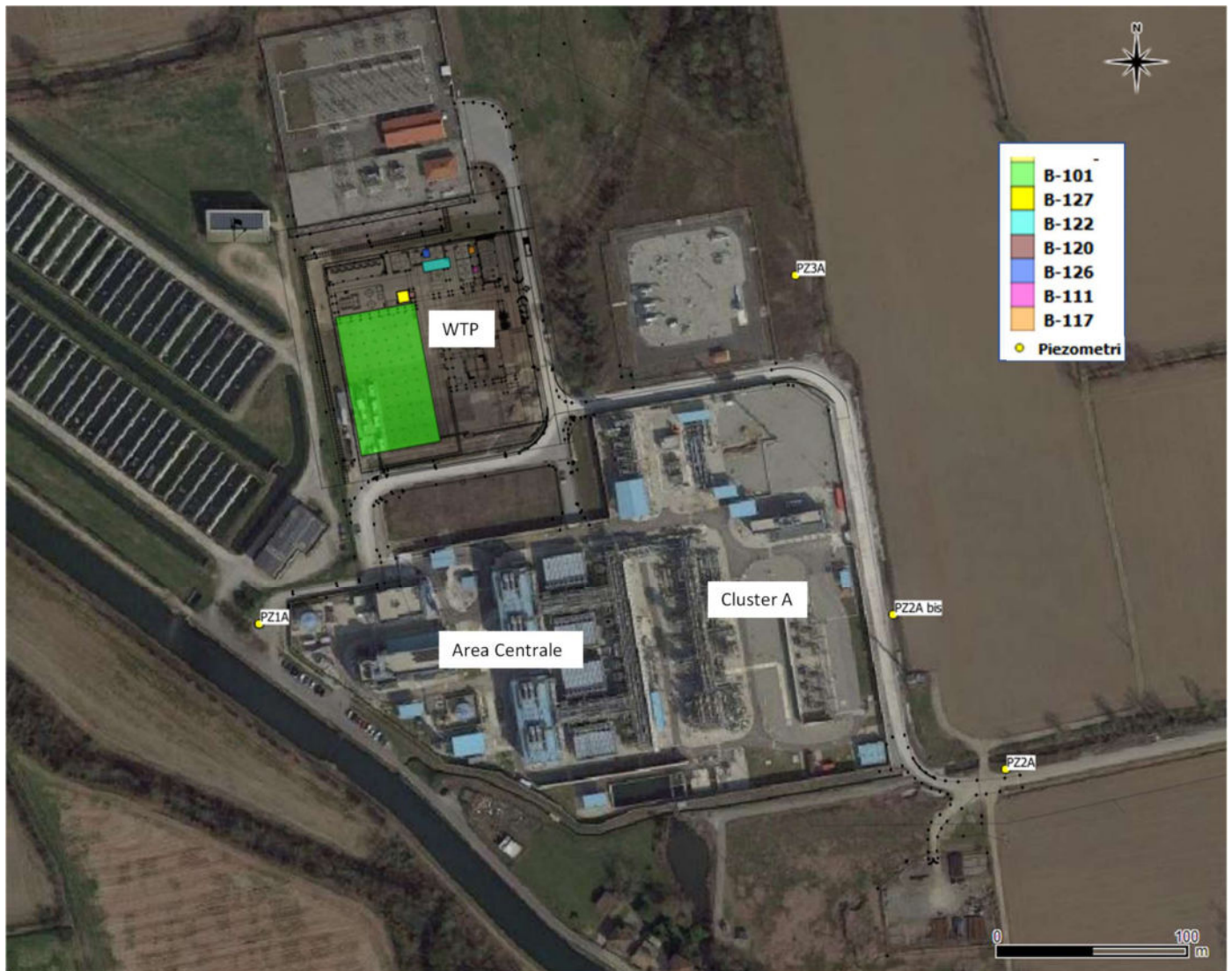
Figura 1-2: Opere WTP interferenti con il flusso di falda e rete piezometrica esistente (zona WTP, area Centrale e Cluster A)
