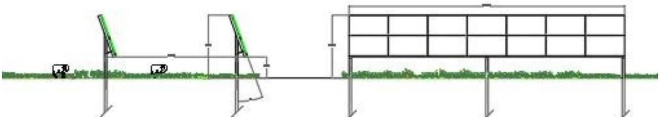
Tale struttura a reticolo viene appoggiata a pilastri di forma rettangolare di medesima sezione ed infissi nel terreno ad una profondità variabile in funzione delle caratteristiche litologiche del suolo. In fase esecutiva la struttura potrà essere sostituito da analoghi modelli, anche di altri costruttori concorrenti in relazione allo stato dell'arte della tecnologia al momento della realizzazione del Parco, con l'obiettivo di minimizzare l'impronta al suolo a parità di potenza installata.
