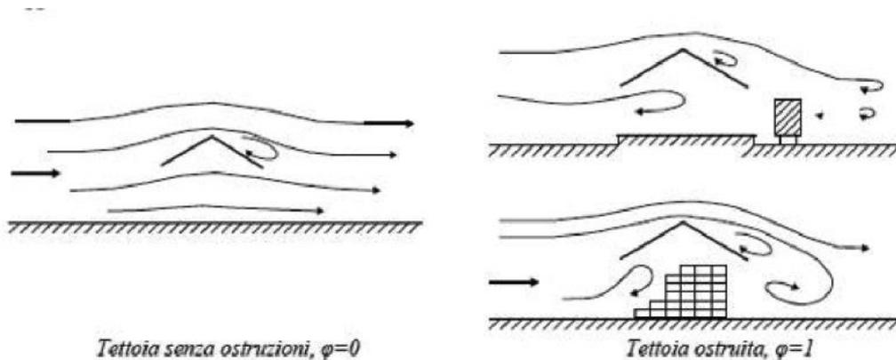
E' importante osservare che le azioni aerodinamiche esercitate del vento sulle tettoie dipendono fortemente dal grado di bloccaggio in quanto la presenza di un'ostruzione, anche soltanto sul lato sottovento, impedisce il passaggio dell'aria al di sotto della tettoia
