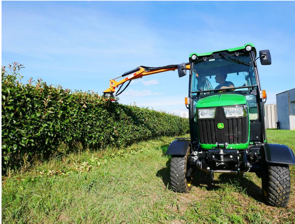
Esempio di potatrice meccanica frontale a doppia barra (taglio verticale + topping) utilizzabile su tutti le colture arboree intensive e superintensive
