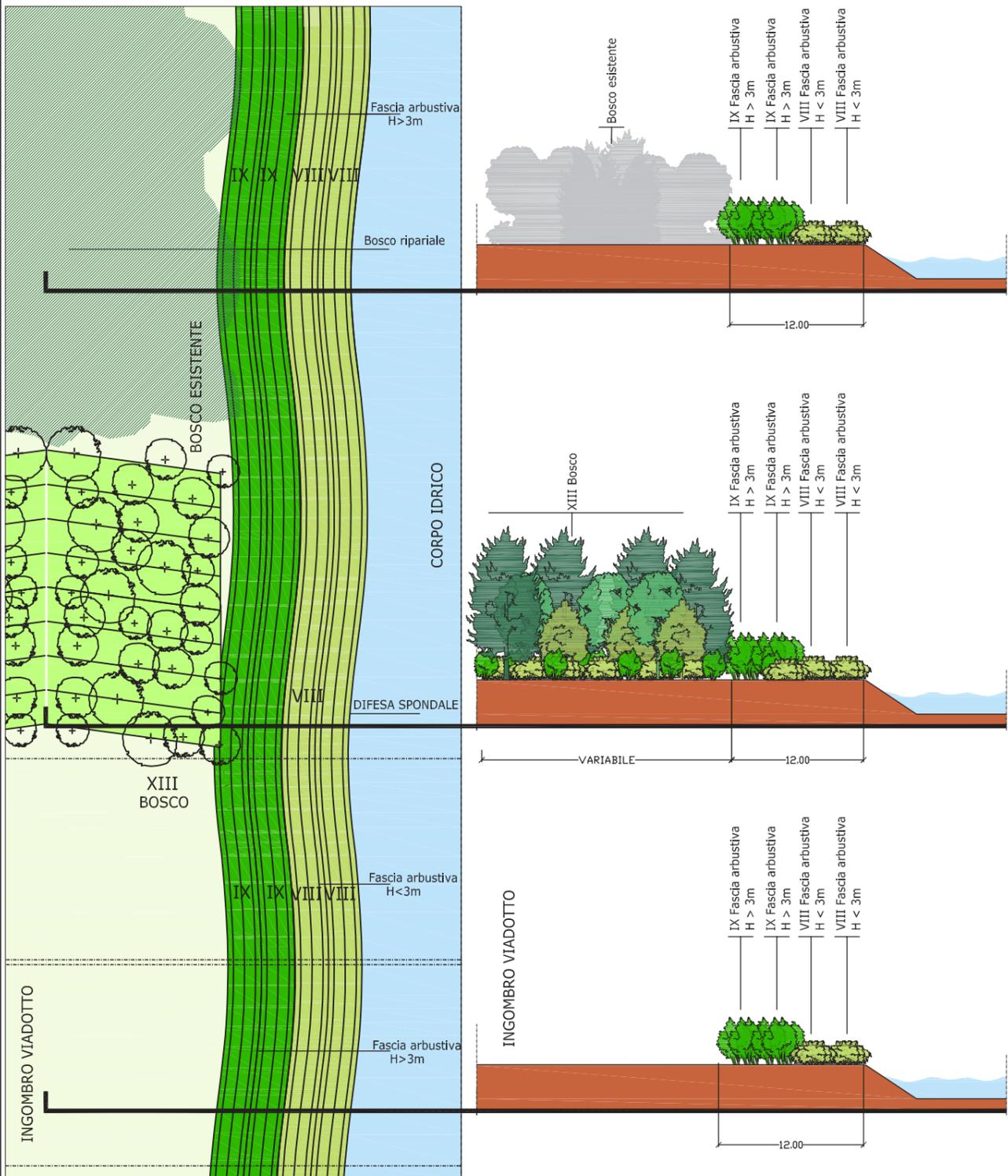
ATTRAVERSAMENTO CORPO IDRICO: RICOSTRUZIONE FASCIA RIPARIALE
