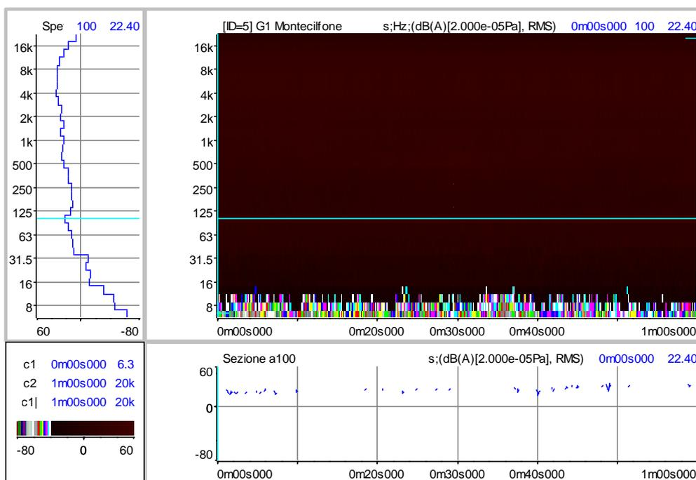
Figura 2 - Sonogramma della misura eseguita sulla proiezione verticale dell'elettrodotto a distanza di circa 30m dal traliccio
