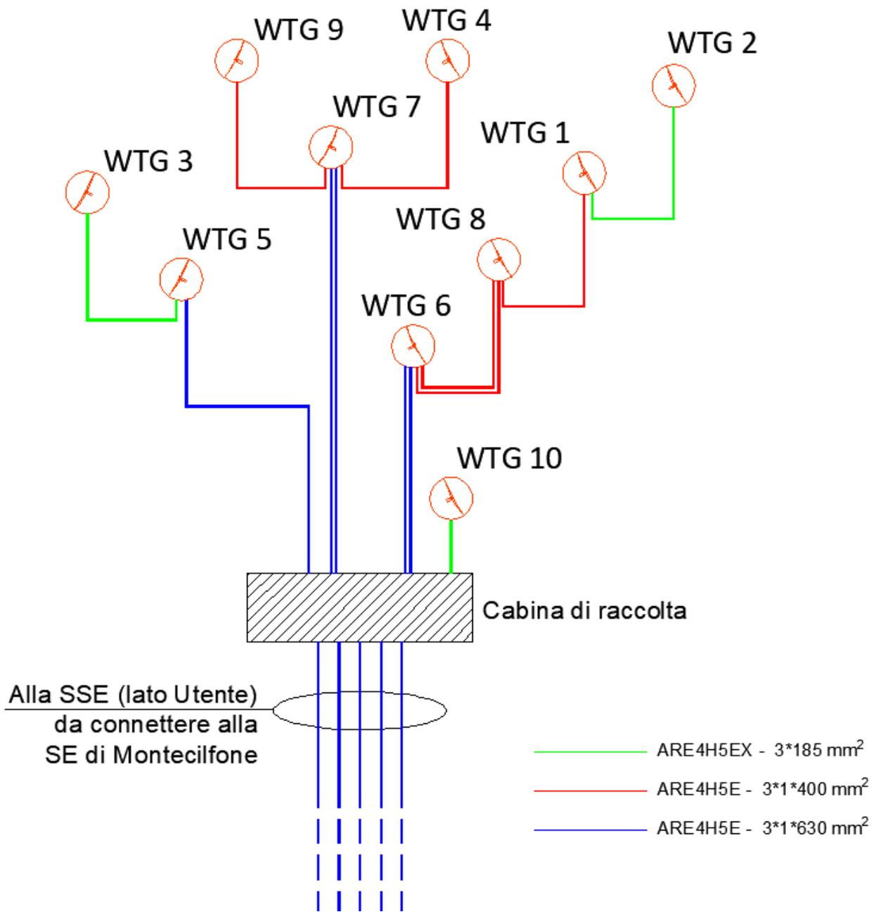
Figura 12 - collegamenti MT, sezione e materiale dei conduttori
