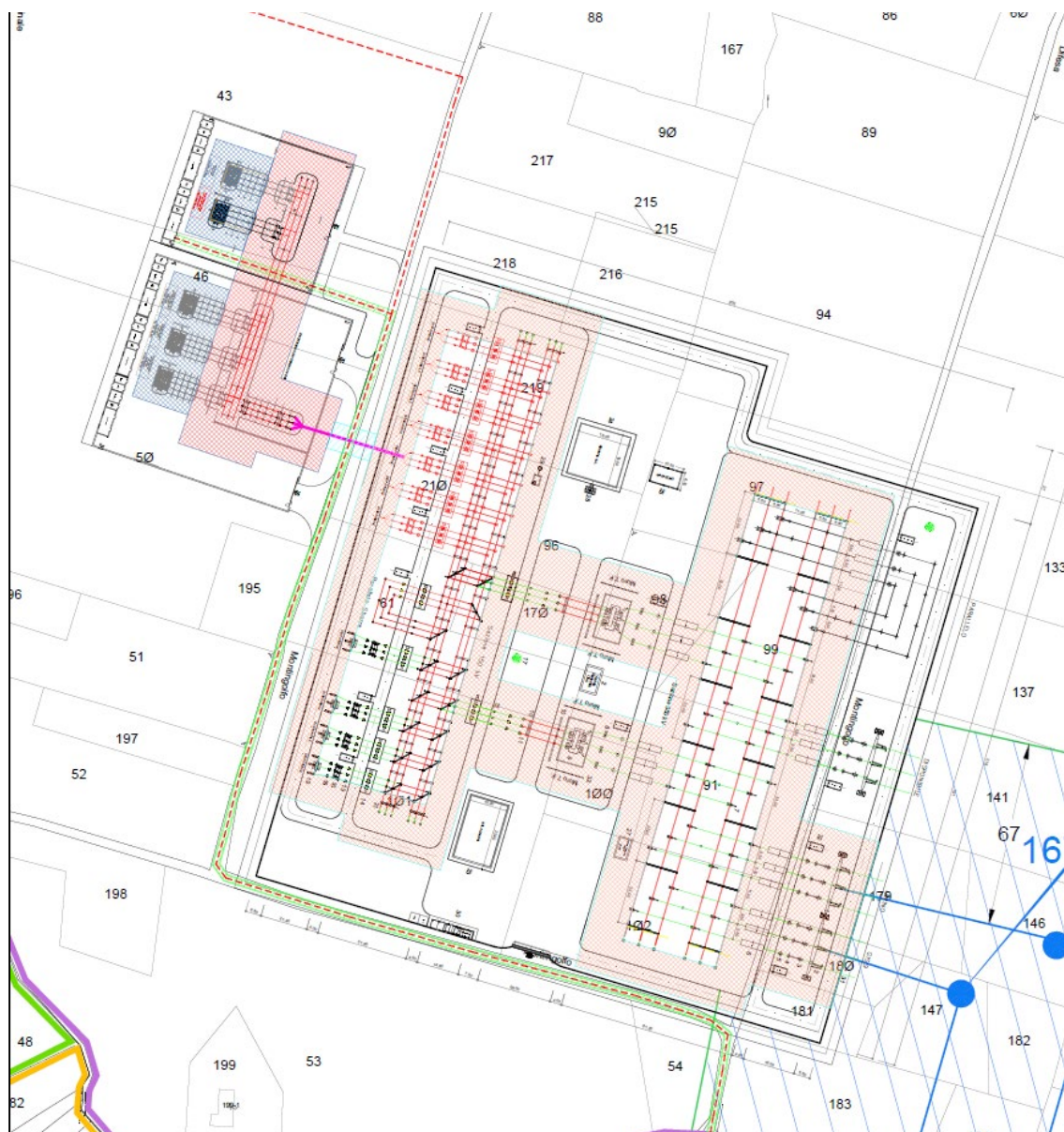
Figura 42 - Stralcio MTN-CIV-TAV-014 - Particolare di connessione alla SE
