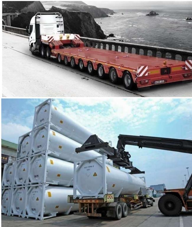
FIGURA 3-16: CARICAMENTO ISO- CONTAINER SU MOTRICE/BILICO RIBASSATO
