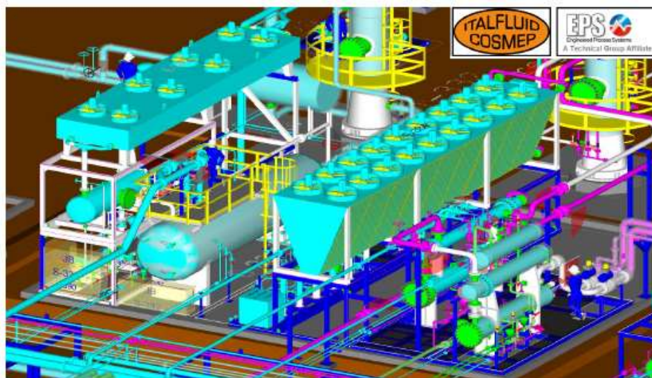
FIGURA 5-6: UNITÀ DI ADDOLCIMENTO (SKID DI INGRESSO S-331, SKID AMMINA LEAN/RICH S-332, SKID AMMINA LEAN S-333, SKID DI RIFLUSSO AMMINA S-334, SKID REINTEGRO ACQUA E AMMINA S-335)
