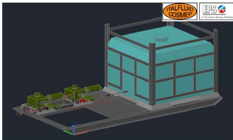
FIGURA 5-3: PACKAGE INIEZIONE INIBITORE DI CORROSIONE CI-190-A
