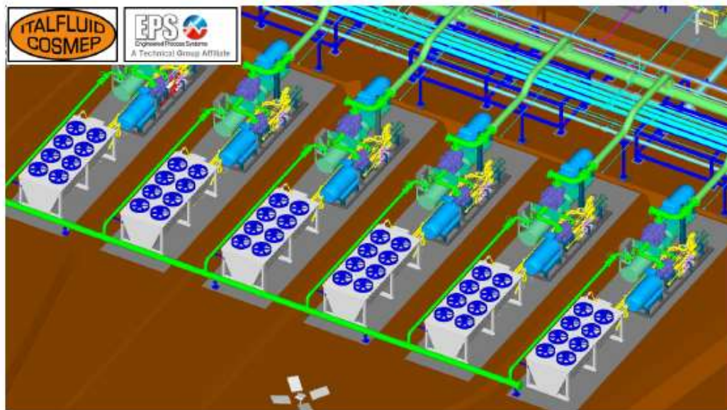
FIGURA 5-12: COMPRESSORI E PRE-RAFFREDDAMENTO (UNITÀ 340 – PK-342 1,2,3,4, S-343)
