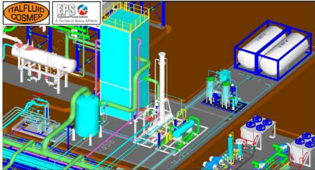
FIGURA 5-13: COLD BOX, NGL AND CONDENSATE VAPORIZER SKID, MIX REFRIGERANT MAKEUP, MR SUCTION KO DRUM E SISTEMA DI RIMOZIONE OLIO (UNITÀ 340 – CB-344, S-346, S-347, V-345, S-348)
