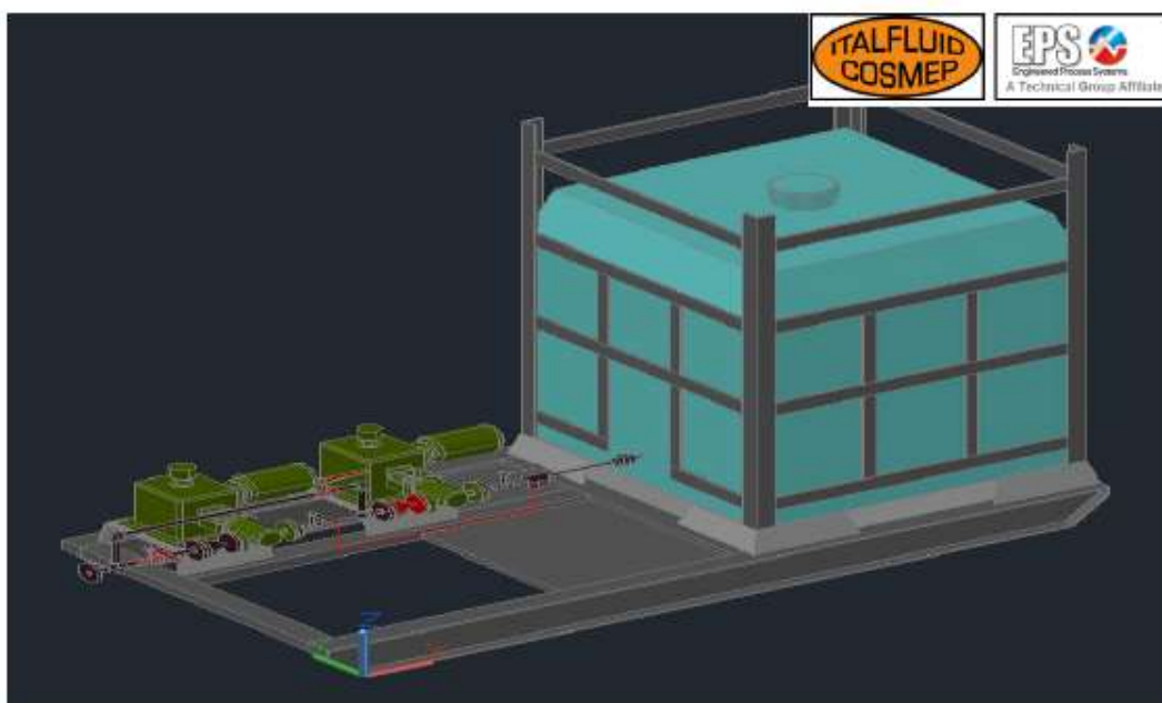
FIGURA 3-3: PACKAGE INIEZIONE INIBITORE DI CORROSIONE CI-190-A
