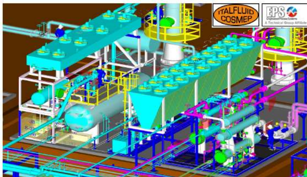
FIGURA 3-6: UNITÀ DI ADDOLCIMENTO (SKID DI INGRESSO S-331, SKID AMMINA LEAN/RICH S-332, SKID AMMINA LEAN S-333, SKID DI RIFLUSSO AMMINA S-334, SKID REINTEGRO ACQUA E AMMINA S-335)
