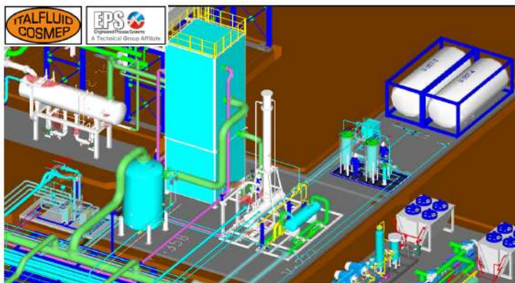
FIGURA 3-13: COLD BOX, NGL AND CONDENSATE VAPORIZER SKID, MIX REFRIGERANT MAKEUP, MR SUCTION KO DRUM E SISTEMA DI RIMOZIONE OLIO (UNITÀ 340 – CB-344, S-346, S-347, V-345, S-348)
