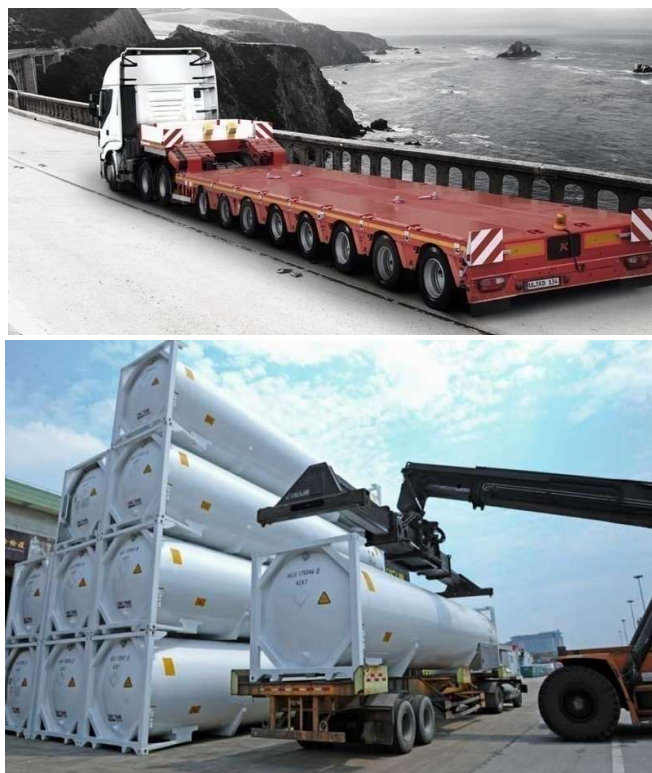
FIGURA 3-16: CARICAMENTO ISO- CONTAINER SU MOTRICE/BILICO RIBASSATO
