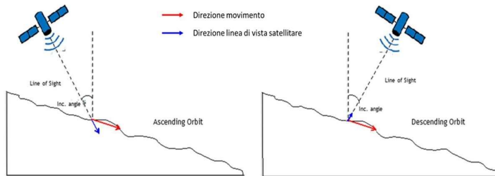
Figura 2-2 - Rappresentazione schematica dell'interazione tra la linea di vista satellitare (LOS) e la topografia locale per un versante con esposizione a Est. In rosso il movimento reale, in blu lo stesso proiettato lungo la LOS satellitare in funzione della geometria orbitale ascendente (sinistra) e discendente (destra).
