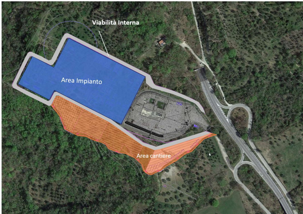
FIGURA 1-1: AREE INTERESSATE DALL'IMPIANTO SMALL SCALE LNG
