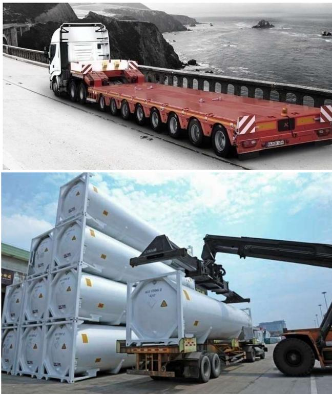
FIGURA 3-17: CARICAMENTO ISO- CONTAINER SU MOTRICE/BILICO RIBASSATO
