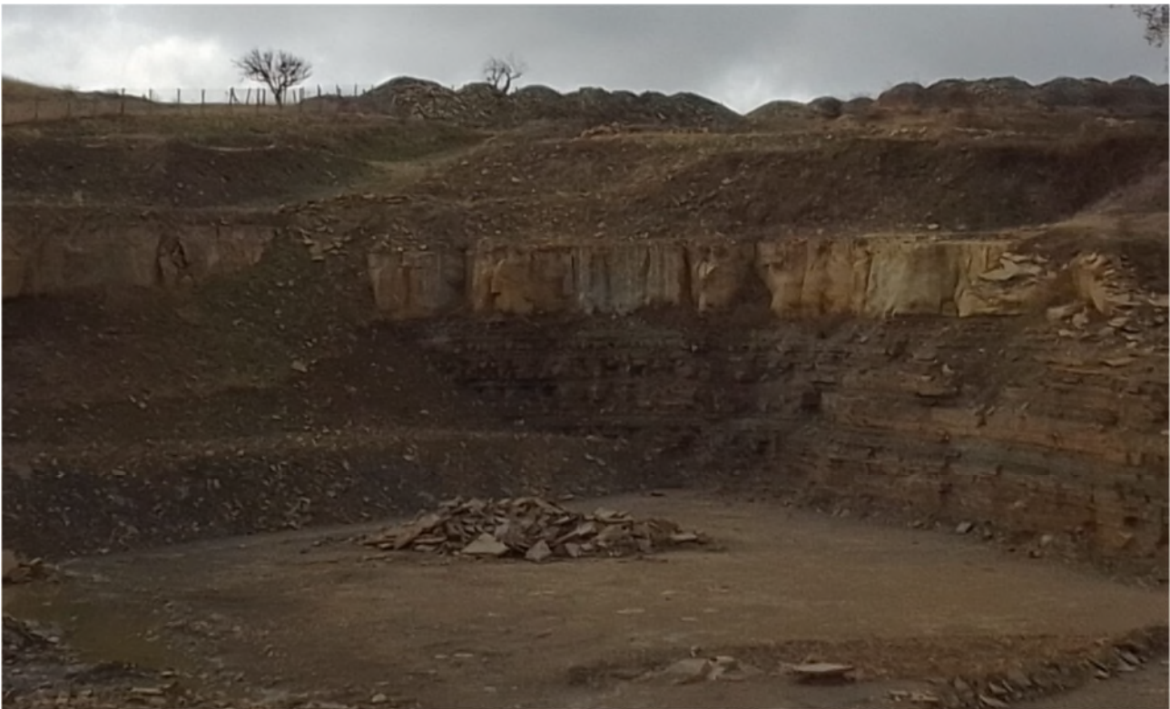
Figura 5 – Foto del fronte di cava in prossimità del piazzale Pozzo GG3. Si nota come il potente bancone arenaceo, di circa 3 metri di spessore, sia dislocato da una faglia ad alto angolo con direzione ca. N60E
