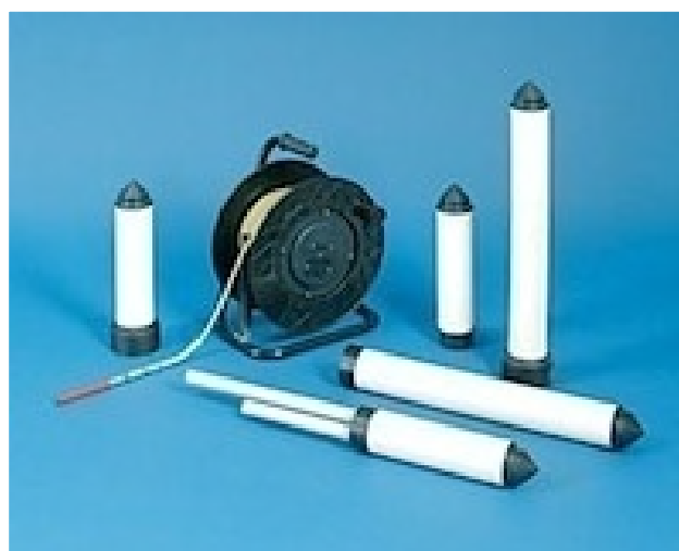
Figura 13 - Componenti di un piezometro di Casagrande e il freatimetro di misura.
