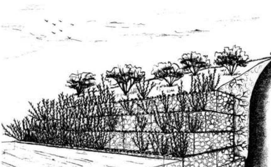
**Figura 2: Vista in prospettiva di Gabbionata in rete metallica zincata rinverdata (Manuale di ingegneria naturalistica applicabile al settore idraulico – scheda 31– Regione Lazio, 2003)**
