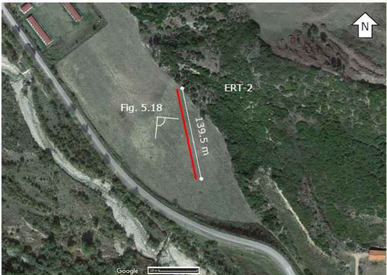
Figura 5.17 - Ubicazione della ERT “Linea Canile” nel Sito 2. Il profilo geoelettrico acquisito è lungo 139,5 m ed è orientato NNO-SSE.
