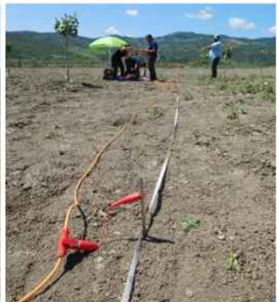
Figura 5.14 - Ubicazione della ERT "Linea Acinello" nel Sito 1. Il profilo geoelettrico acquisito è lungo 139,5 m ed è orientato circa NE-SO.
