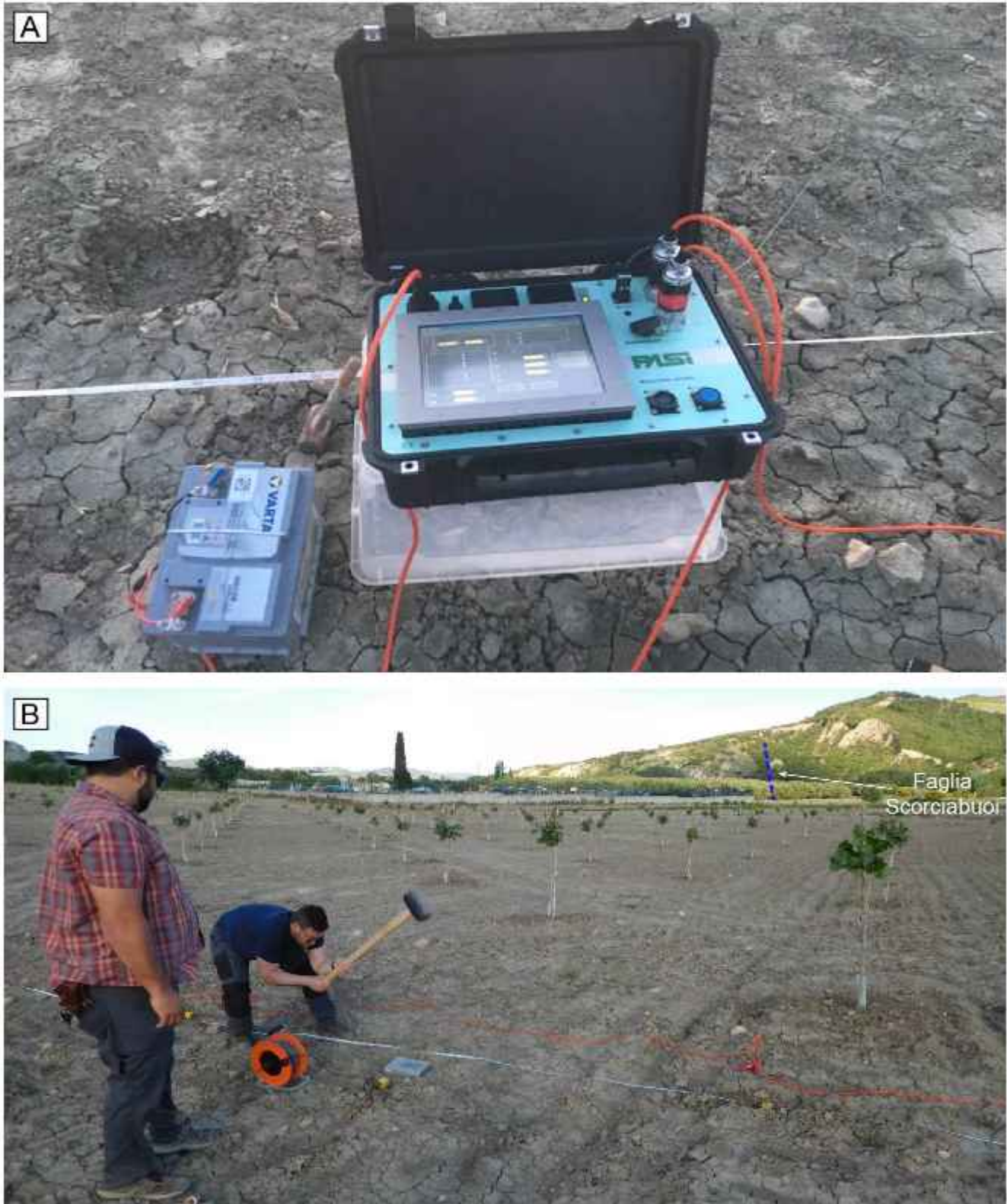
Figura 5.3 - Strumentazione utilizzata per l'acquisizione dei dati sismici: a) Strumentazione PASI 16SG-N per metodi sismici (24 canali) ed elettrici (32 canali); b) Energizzazione con mazza di 8 kg.
