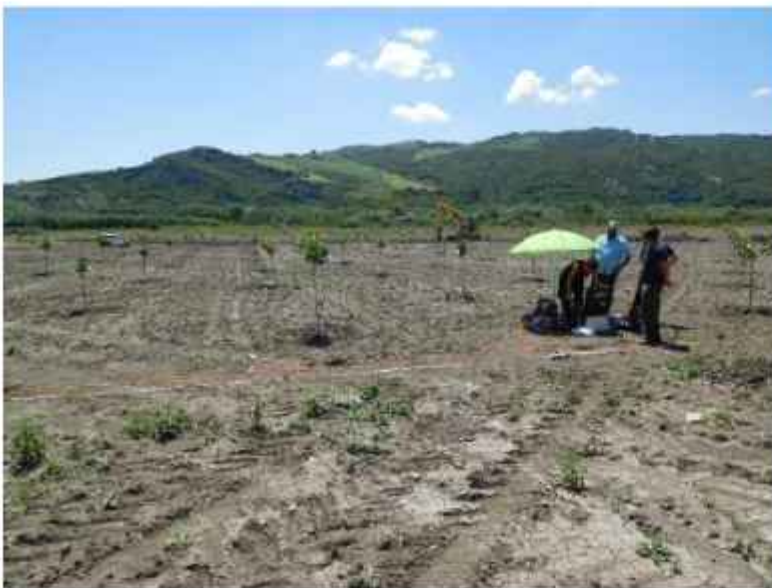
Figura 5.14 - Ubicazione della ERT "Linea Acinello" nel Sito 1. Il profilo geoelettrico acquisito è lungo 139,5 m ed è orientato circa NE-SO.
