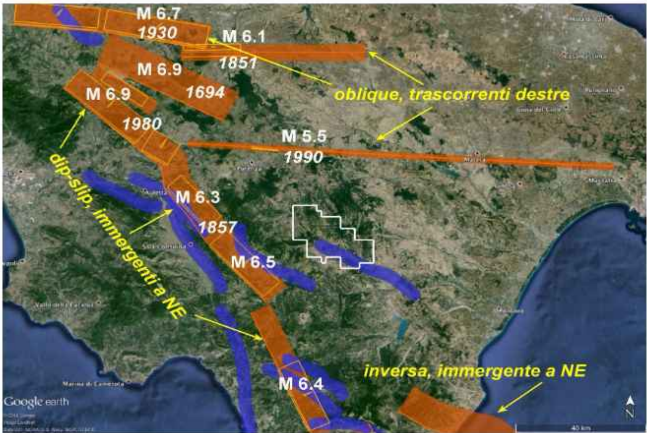
Figura 3.4 - Sintesi delle sorgenti sismogenetiche che insistono sul settore dell'appennino-avampaese apulo che circonda la concessione in oggetto (perimetro bianco). In bianco: anno e magnitudo dei principali terremoti di cui sono note Individual Sources (IS, rettangoli giallo-arancio). In colore arancio: Composite Sources (CS). In sfondo blu: Debated Sources (DS). Dati: DISS ( http://diss.rm.ingv.it/diss , versione 3.2.0)
