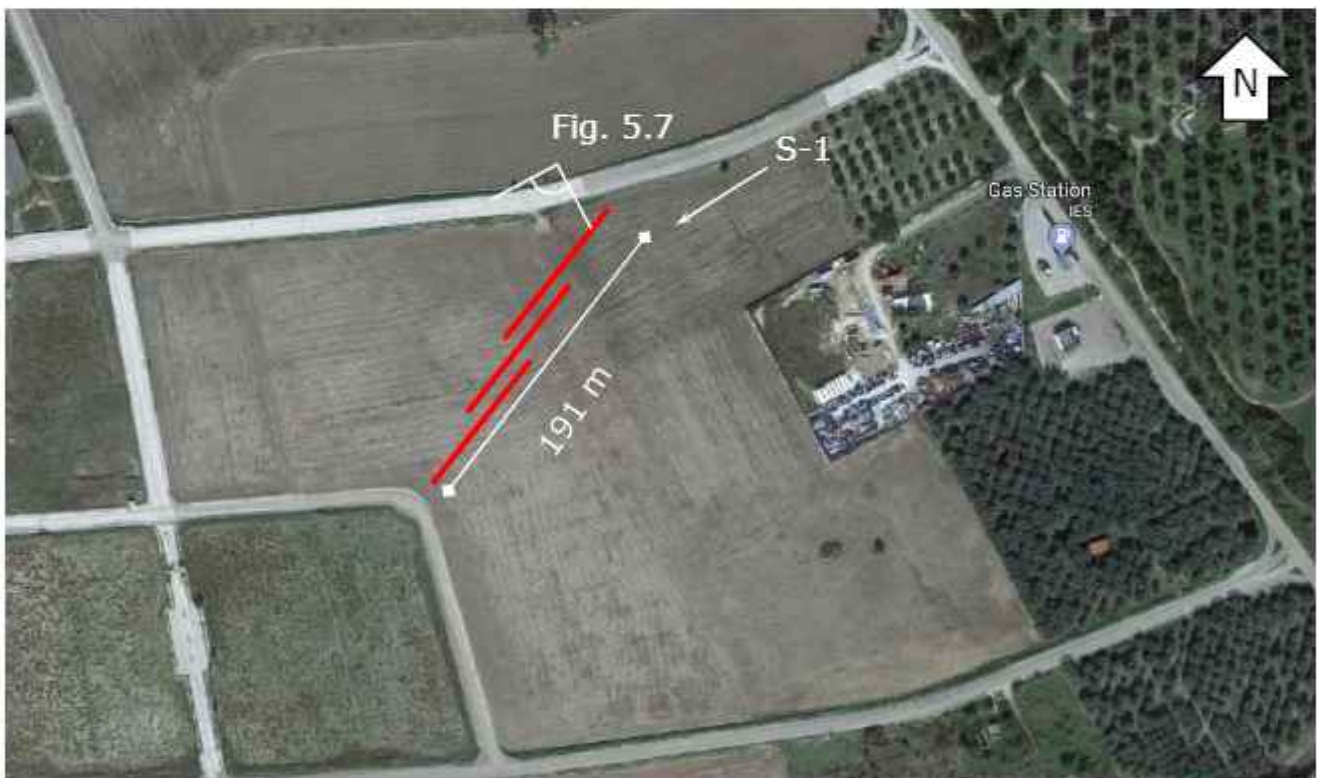
Figura 5.6 - Ubicazione delle sezioni sismiche del sito n.1 "Linea Acinello", composto da tre stendimenti della lunghezza di 191 metri ed orientata circa N40°.
