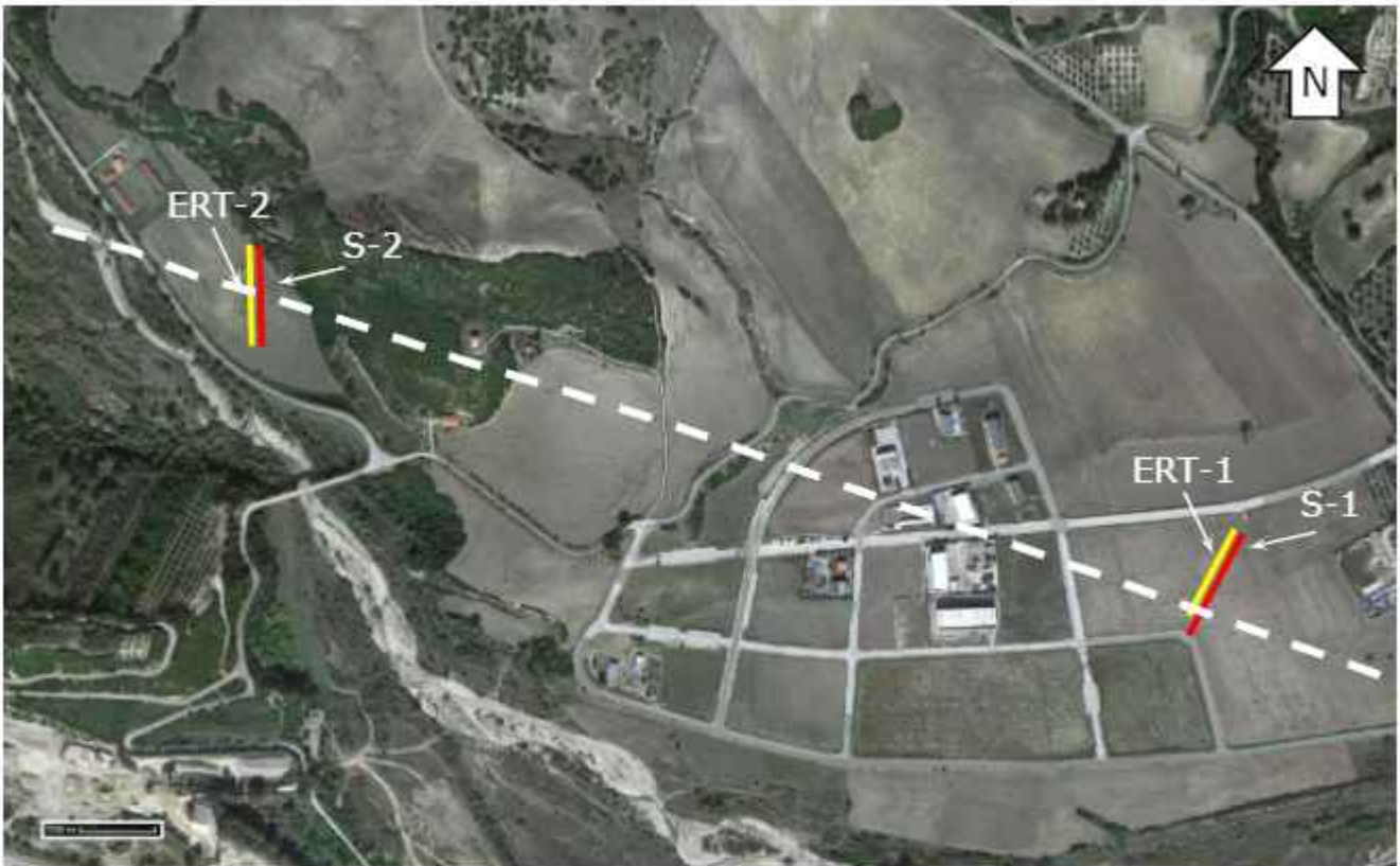
Figura 5.1 - Ubicazione degli stendimenti geofisici nell'area della piana alluvionale del Fiume Sauro, in località Acinello. In giallo sono riportate le sezioni ERT e in rosso le sezioni per la sismica a rifrazione.
