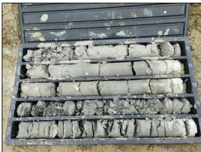
Sondaggio 5 - Cassetta 3 - da 10,00 a 15,00 metri
