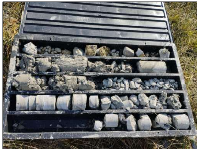
Sondaggio 1 - Cassetta 2 - da 5,00 a 10,00 metri
