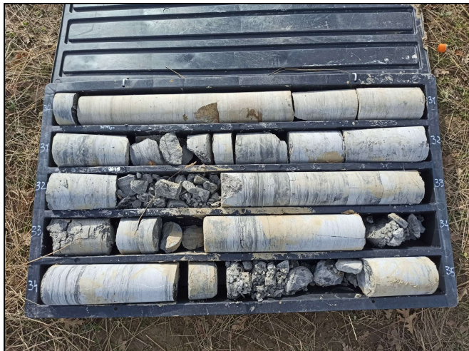
Sondaggio 1 - Cassetta 17 - da 30,00 a 35,00 metri
