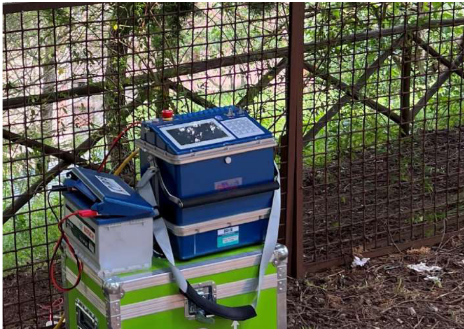
Figura 4 Strumentazione SISCAL Terra con sistema multielettrodo per Tomografia di Resistività Elettrica.
