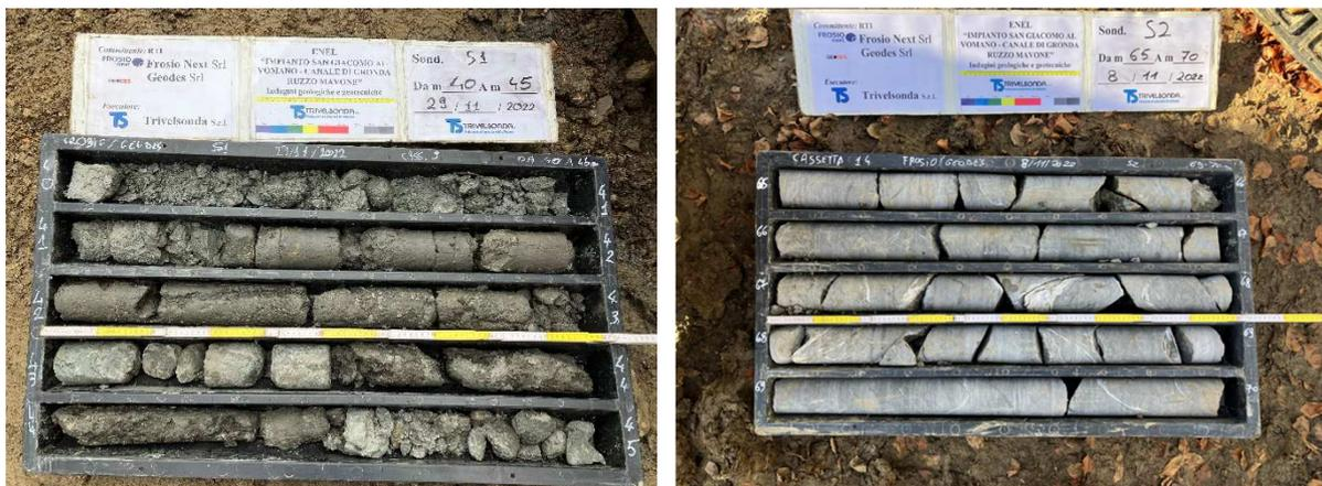
Durante l'esecuzione dei sondaggi sono stati prelevati campioni rimaneggiati di roccia e terreno da sottoporre a prove di tipo geotecnico, inoltre, nel foro di sondaggio, sono state eseguite prove idrauliche di assorbimento tipo Lugeon, prove dilatometriche ed un rilievo con sonda BHTV.
