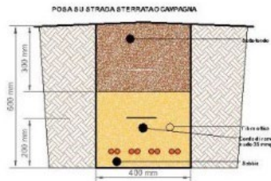
Figura 18 - Particolare sezione tipo cavo interrato BT
