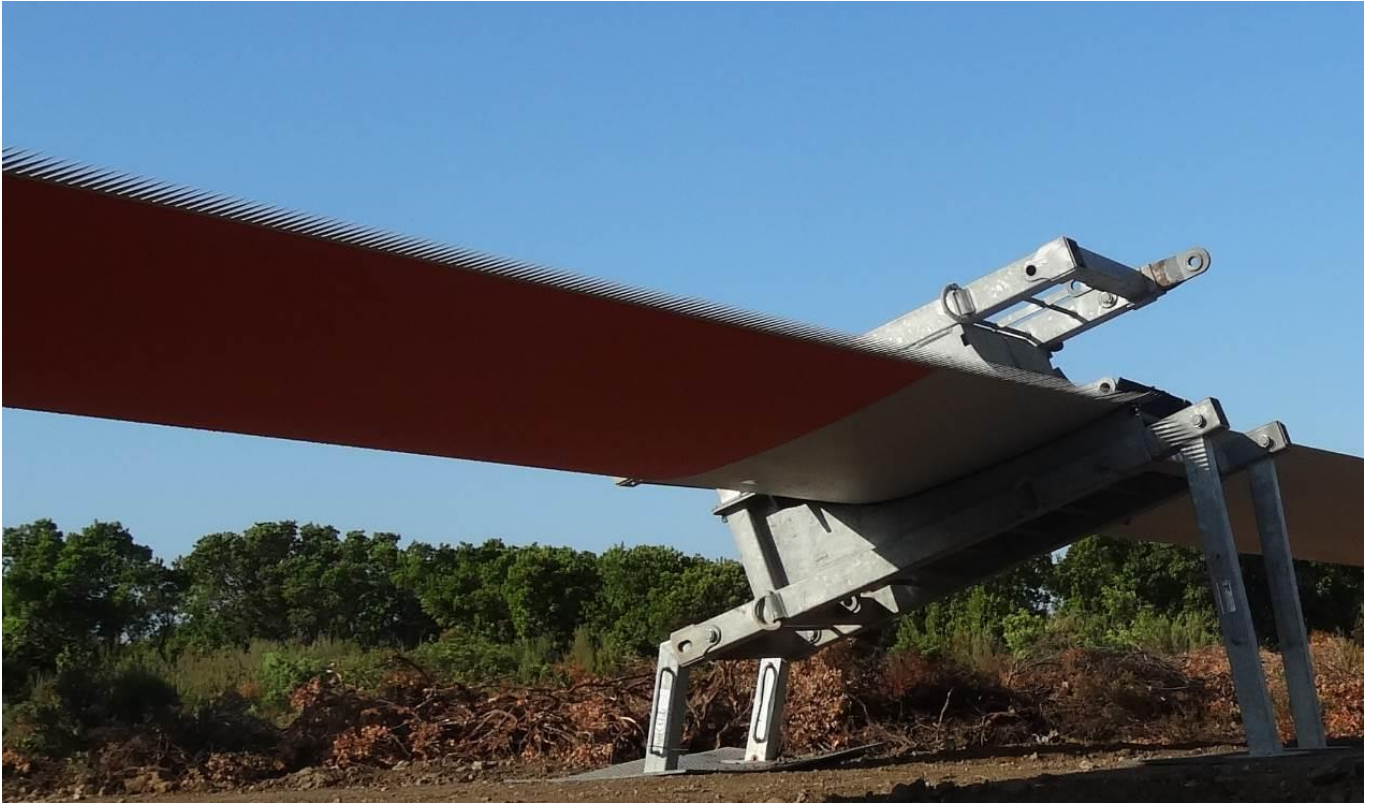
Figura 45: pala di aerogeneratore con bande dentellate.
