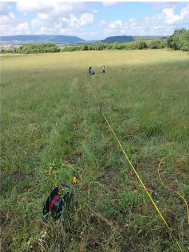
**Sismica a Rifrazione/Masw SMT01
