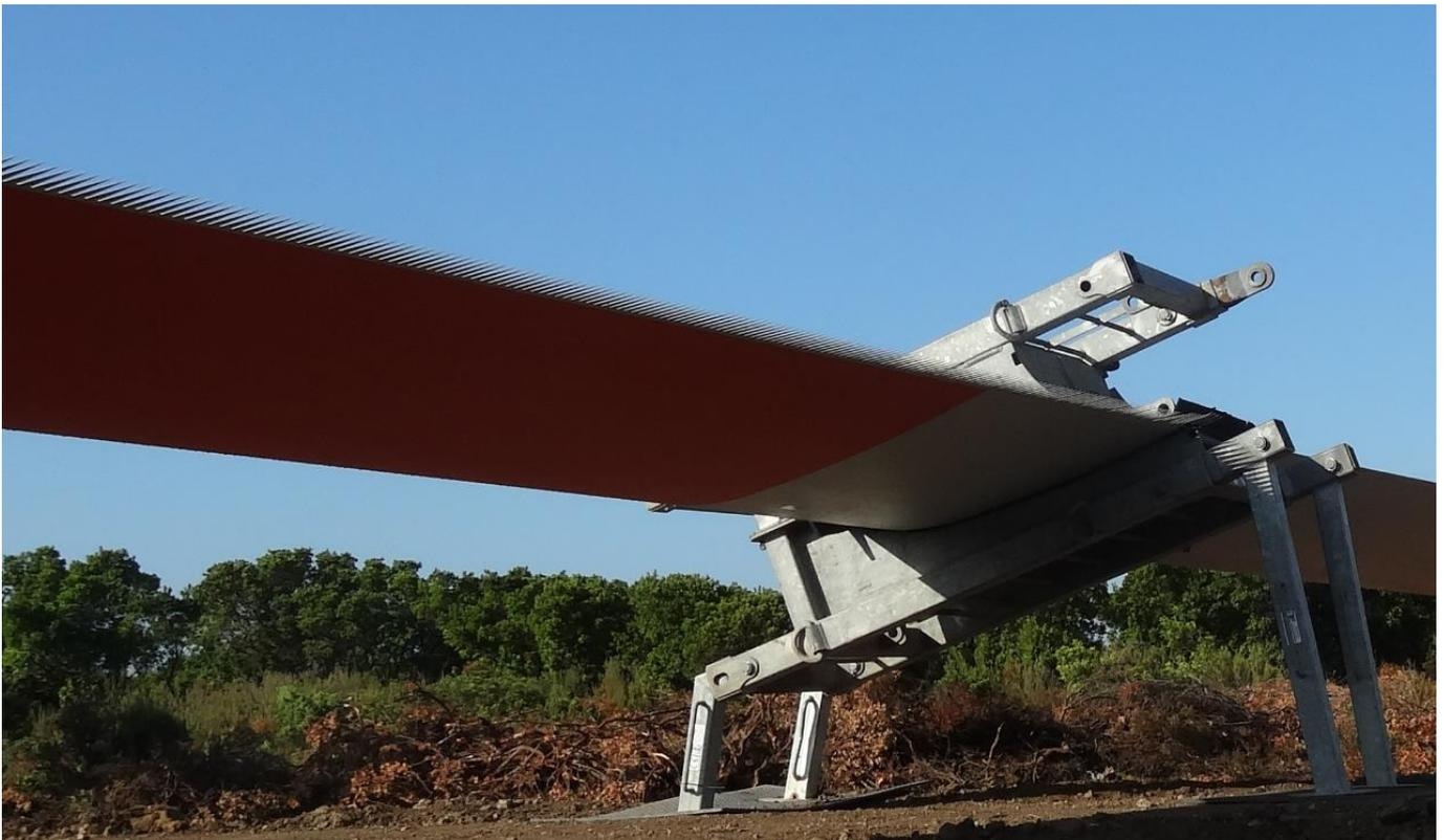
*Figura 7 Pala di aerogeneratore con bande dentellate*
