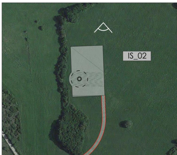
Figura 8. Posizione della piazzola su foto da satellite e vista del punto di Lay-out del previsto aerogeneratore IS02 (Scala 1:2000; dalle Tavole tecniche: IS_PC_T008.3 - Tavola Piazzole_2023-09-06_bozza).
