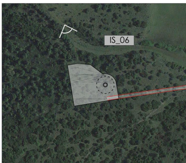
Figura 12. Posizione della piazzola su foto da satellite e vista del punto di Lay-out del previsto aerogeneratore IS06 (Scala 1:2000; dalle Tavole tecniche: IS_PC_T008.3 - Tavola Piazzole_2023-09-06_bozza).
