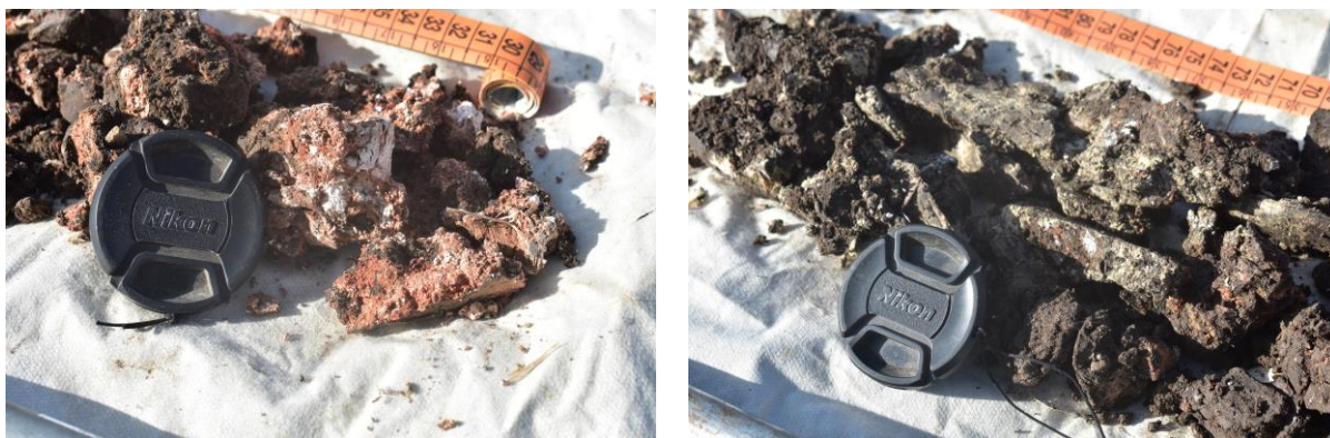
Figura 8 – A sinistra dettaglio dell'orizzonte Bk a destra dettaglio dell'orizzonte Abk. La netta differenza di colore tra i due orizzonti (molto più scuro in profondità) può essere giustificata da eventi passati che hanno determinato la sepoltura di un antico orizzonte A cui fenomeno viene evidenziato associando la lettera b.
