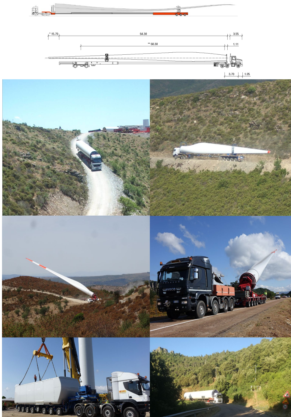
FIG. 19 – FASI DI TRASPORTO E TIPOLOGIA DEI MEZZI UTILIZZATI PER I TRASPORTI
