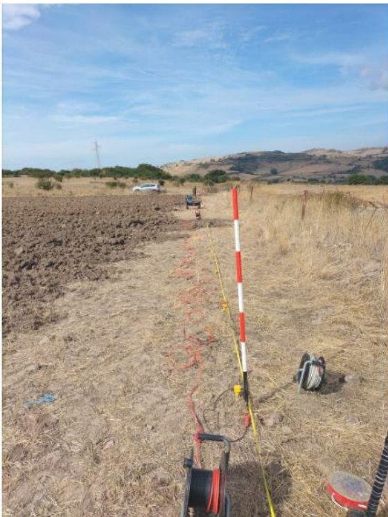
Sismica con metodo Masw M1 dal Geofono 24 al Geofono 1
