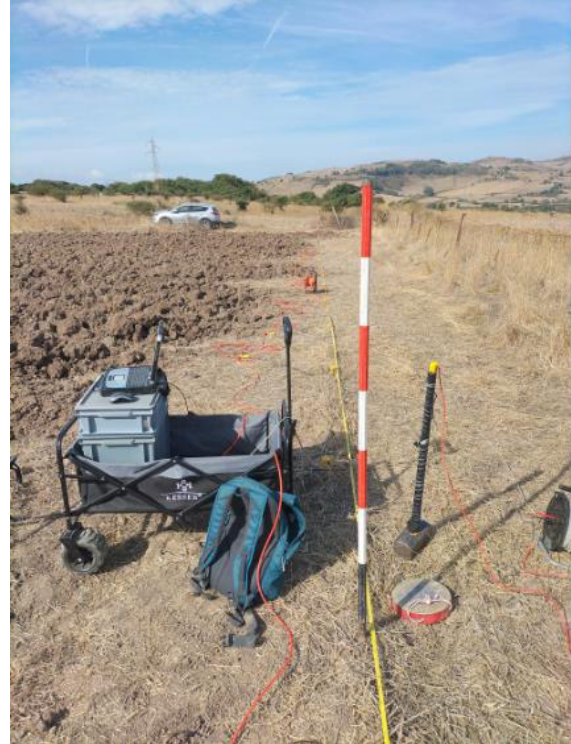
Sismica con metodo Masw M1 dal centro al Geofono 24
