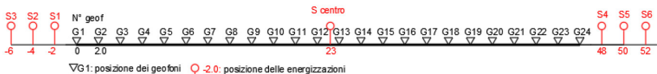
Figura 34 Schema geometrico di acquisizione dei dati per gli stendimenti di lunghezza L = 46,0 m
