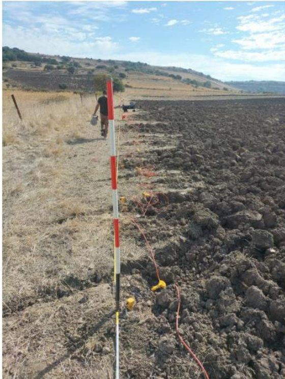
Sismica con metodo Masw M1 dal Geofono 24 al Geofono 1
