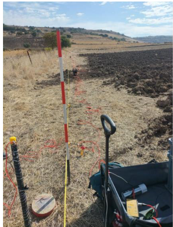
Sismica con metodo Masw M1 dal centro al Geofono 24
