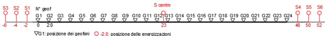
Figura 7 Schema geometrico di acquisizione dei dati per gli stendimenti di lunghezza L = 46,0 m
