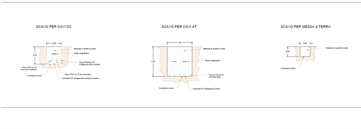
TIPOLOGICI DEGLI SCAVI PER CAVIDOTTO ESTERNO
