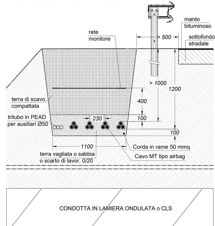
ATTRAVERSAMENTO DI RIGOLO O RUSCELLO CON UN CAVO AIRBAG
