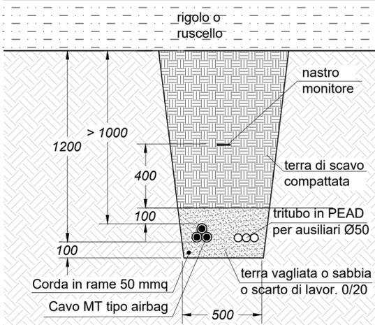
ATTRAVERSAMENTO DI RIGOLO O RUSCELLO CON UN CAVO AIRBAG
