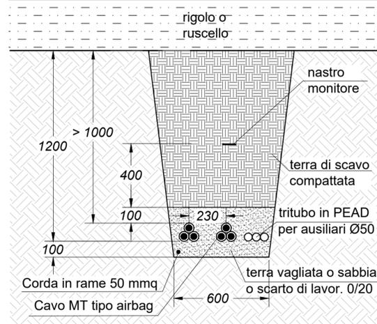
ATTRAVERSAMENTO DI RIGOLO O RUSCELLO CON CAVI AIRBAG
