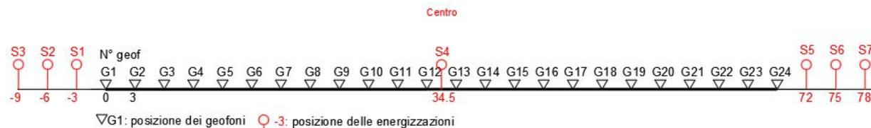
Figura 15 Geometria di acquisizione - MASW con 24 geofoni, interdistanza di 3,0 m, lunghezza complessiva 69,0
