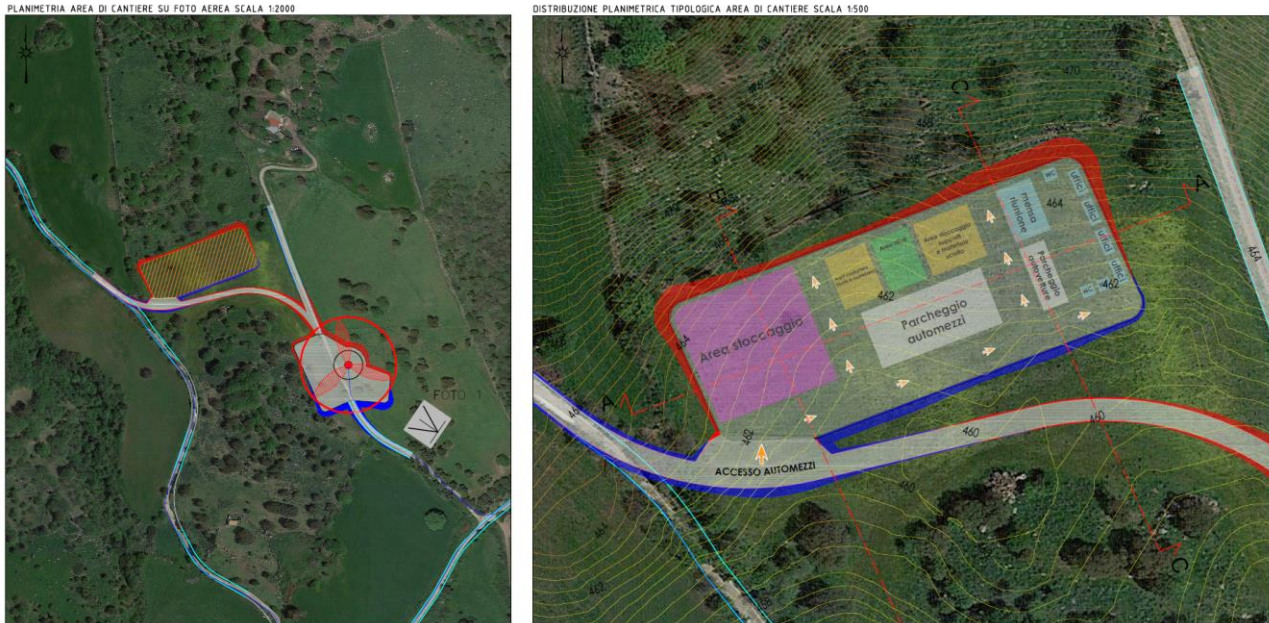
Figura 10: schematizzazione dell'area di accantieramento principale
