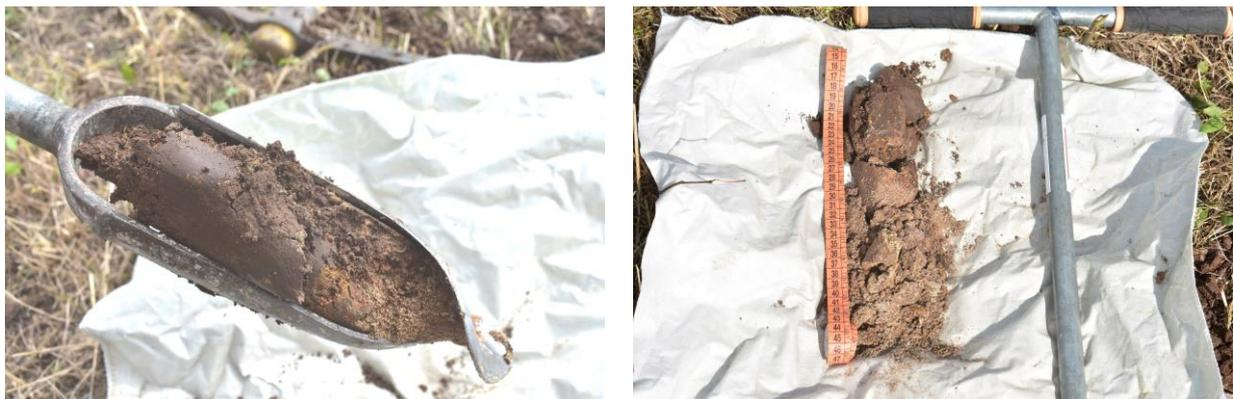
**Figura 22 – Dettaglio del cambio pedologico tra l'orizzonte Ap e C**
