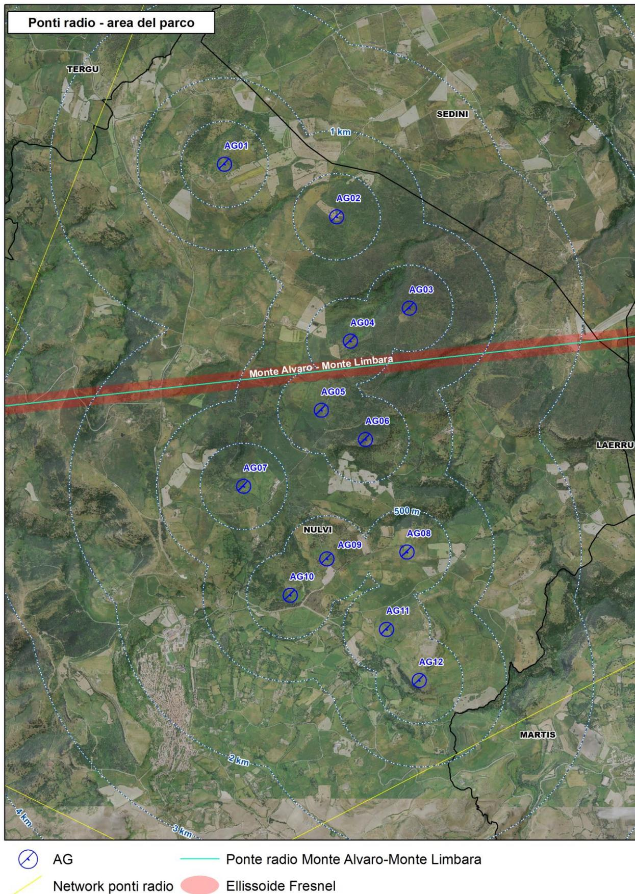
Figura 8: Interferenza Ponte radio Monte Alvaro – Monte Limbara nell'area di progetto.
