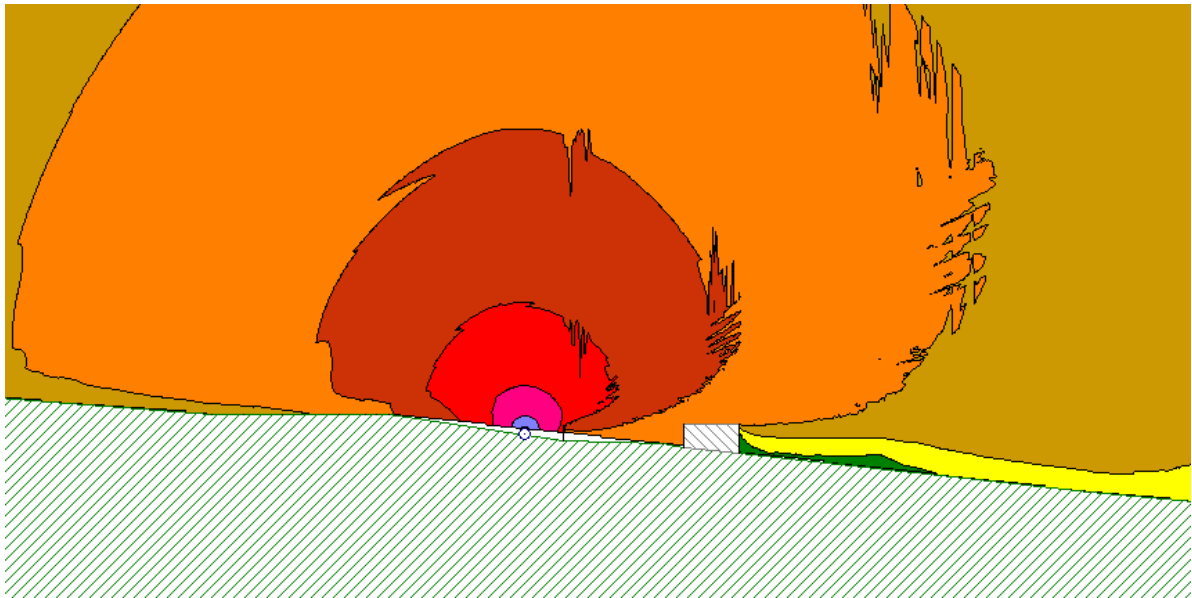
Figura 7 Rumore generato dalla lavorazione di posa cavidotto prima e dopo le opere di mitigazione riceettore RC01
