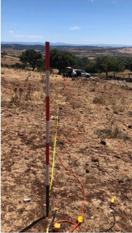
**Sismica a Rifrazione R3
