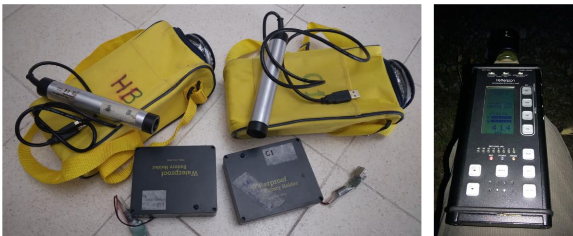
Figura 33. I bat detector utilizzati in questo studio: a destra il sofisticato bat detector multifunzione D1000x Pettersson 1000; a sinistra due dei 5 microfoni audio-ultrasonici Ultramic 384K di Dodotronic. Entrambi registrano i contatti ultrasonici full spectrum con una massima frequenza di 384 kHz e su file wav, con una durata pre-impostata di 5 secondi (su una scheda di memoria interna). L'autonomia degli Ultramic 384K – con power bank di 3 pile D- può arrivare a sette notti consecutive, con registrazione su 8-9 ore per notte.
