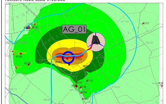
Curve isofoniche lavori di realizzazione della fondazione dell'aerogeneratore AG\_01 presso il ricettore R026 scala 1:10.000
