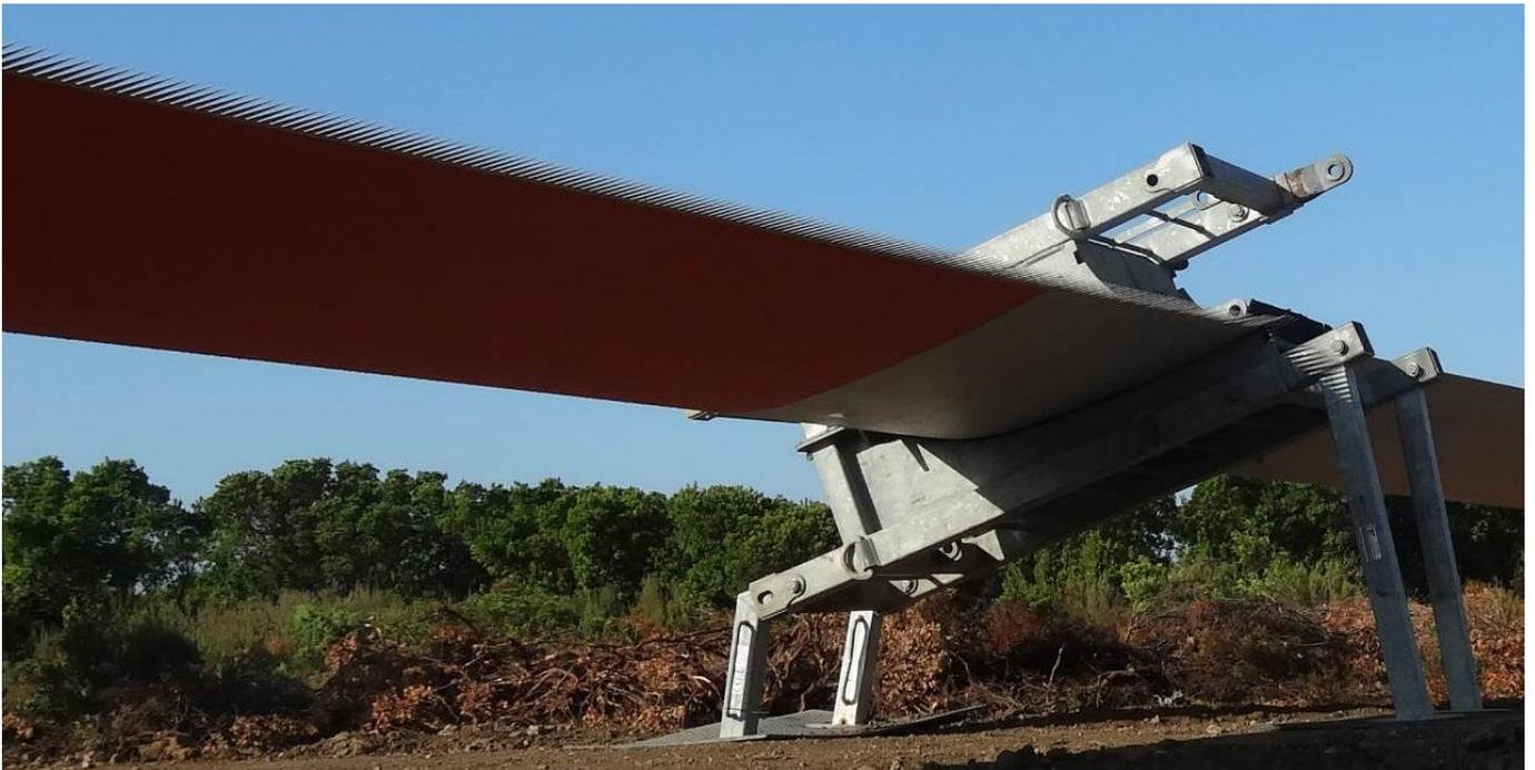
Figura 43: pala di aerogeneratore con bande dentellate.
