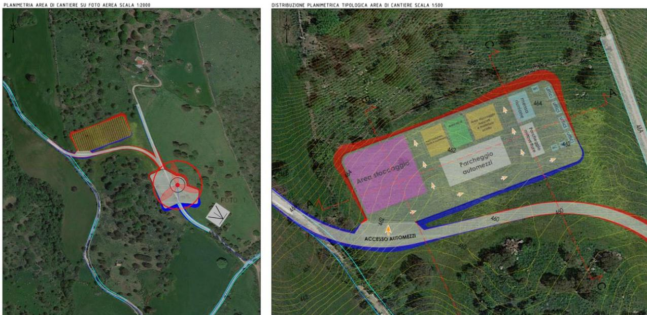
Figura 12: schematizzazione dell'area di accantieramento principale.
