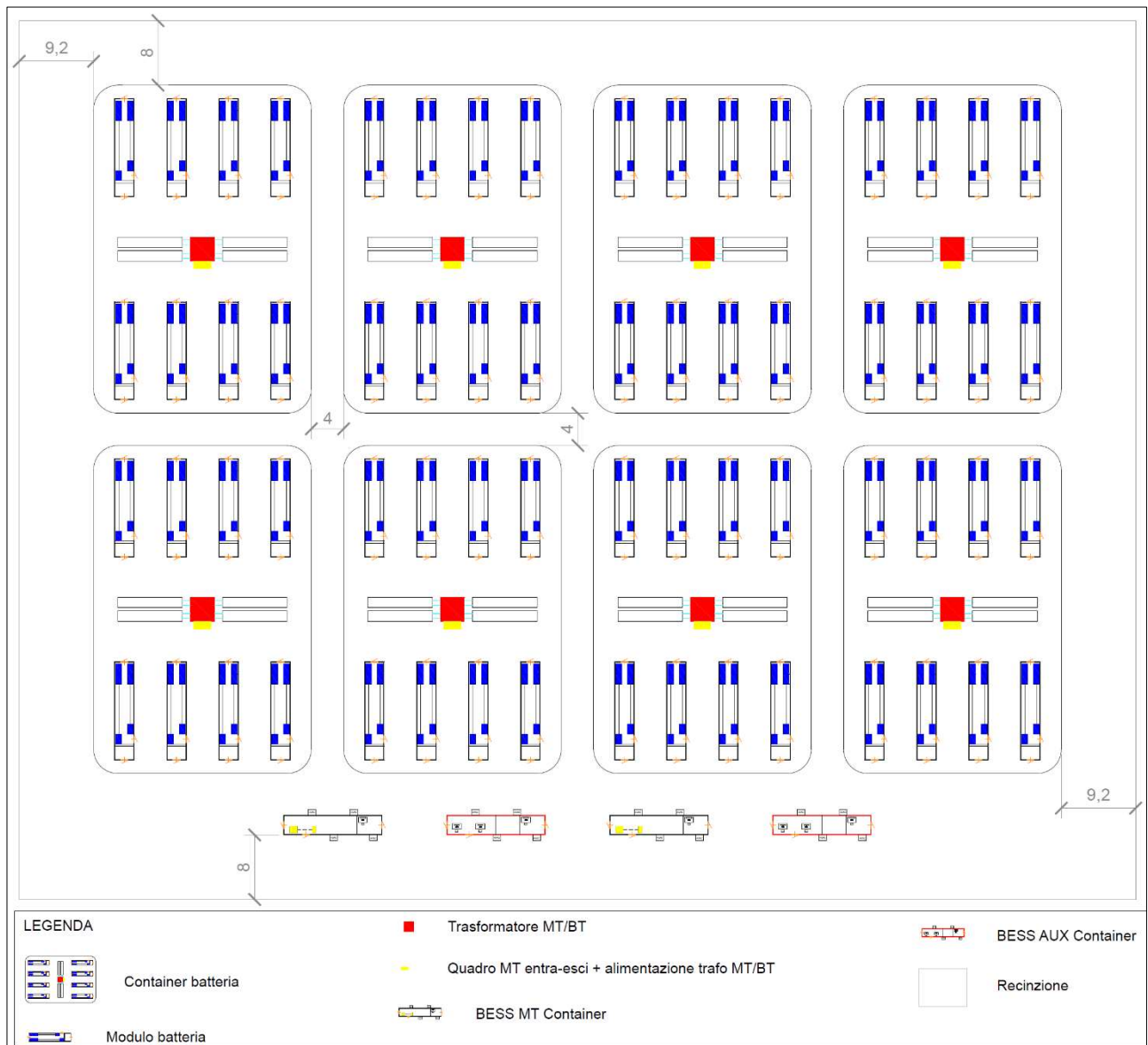
Figura 2.3.2.2: Configurazione dell'impianto BESS
